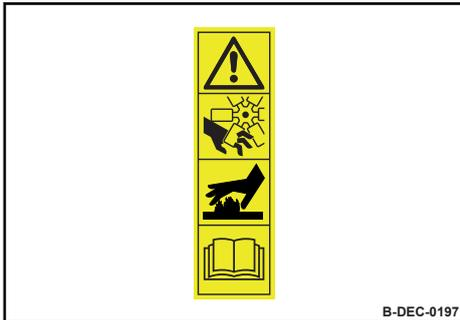
Warnschild - Einzugsgefahr beim Kühlerlüfter und heiße Oberfläche und Betriebsanleitung beachten
