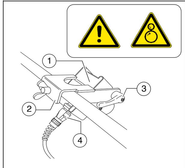
Die Anschlusskabel (4) werden mit den zugehörigen Steckdosen am Fernbedienungshalter verbunden.
