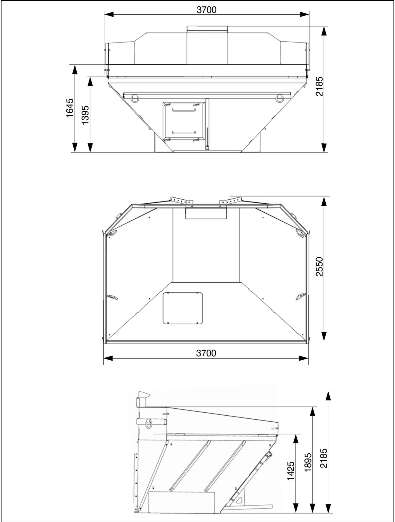
**Abmessungen, Kübel MH2550 - (Ausführung lang)**
