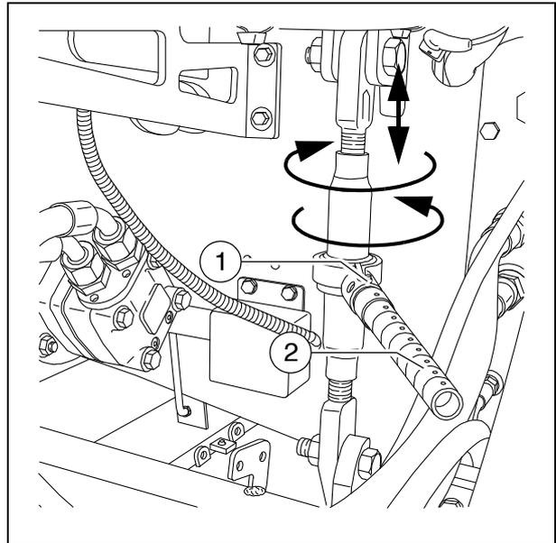
☞ Die aktuelle Höhe kann auf den beiden Schneckenhöhen-Anzeigen abgelesen werden.
