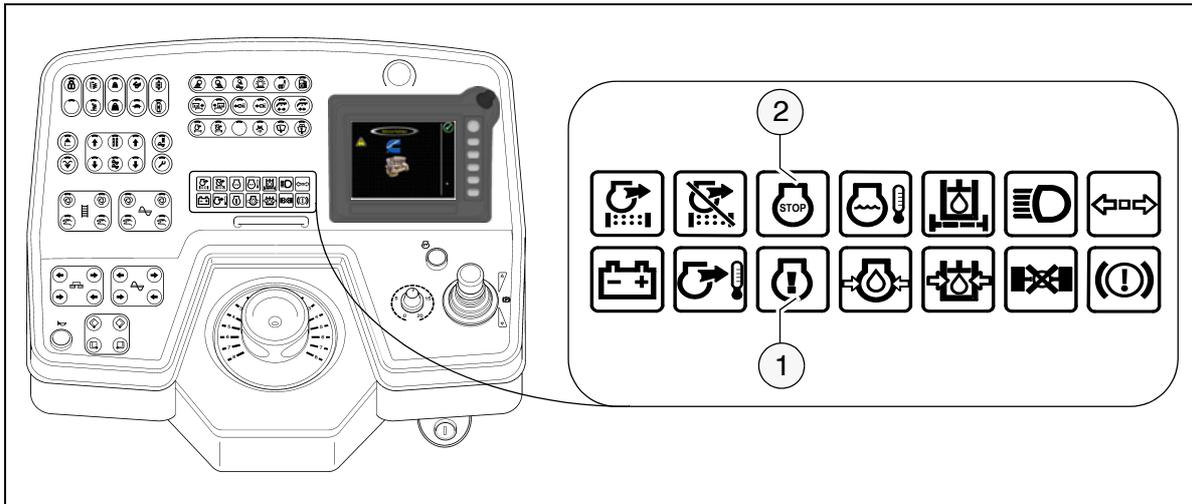
Wurde am Antriebsmotor ein Fehler festgestellt, wird dieser durch die entsprechende Warnleuchte (1) / (2) signalisiert und gleichzeitig als Warnmeldung im Display angezeigt.
