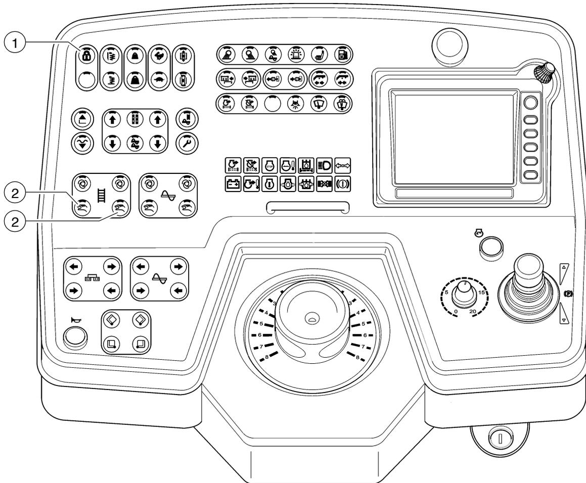
Die Förderrichtung des Lattenrostes lässt sich in die umgekehrte Richtung umschalten, um evtl. kurz vor der Schnecke liegendes Einbaumaterial ein Stück zurück zu fördern. Auf diese Weise lassen sich z.B. Materialverluste bei Transportfahrten vermeiden.
