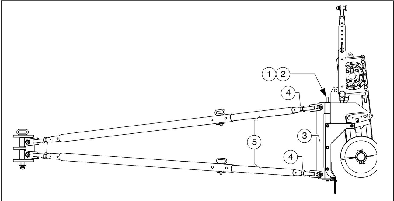
Die Höhenverstellung der Schnecke kann bei großen Arbeitsbreiten mit angeschlagener Abstrebung vorgenommen werden:
