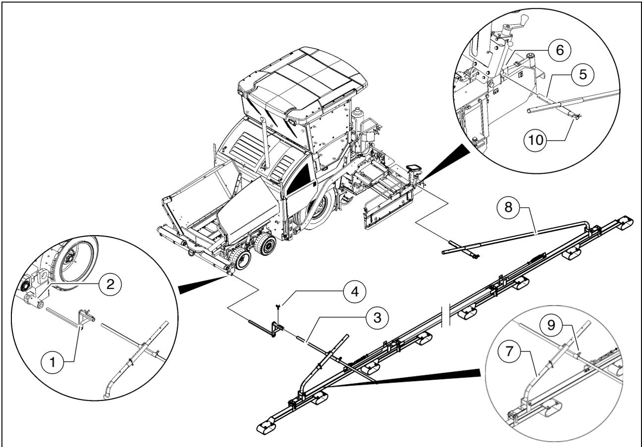
Der Schleppski umfasst einen über mehrere Gelenke beweglichen, auf der Referenzoberfläche laufenden Ski und einen Rotary Sensor, der einen auf dem Ski befindlichen Referenzdraht abtastet.
