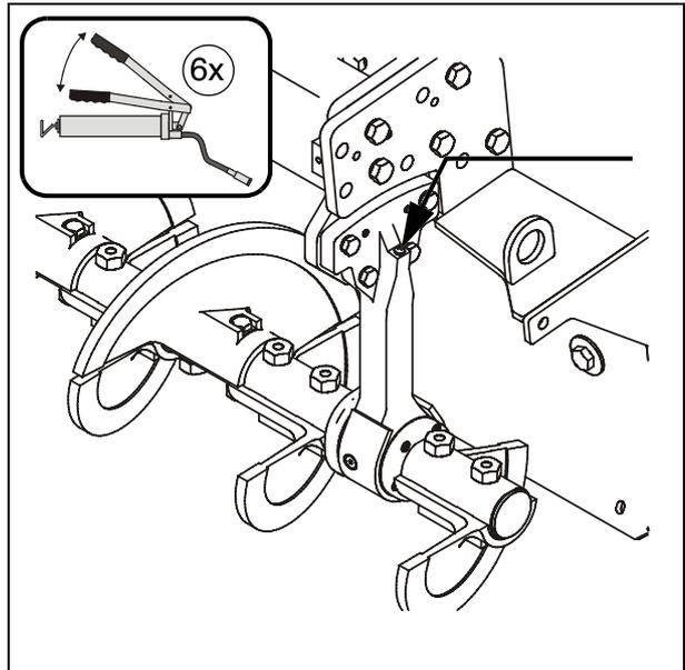
Al ser efectuado el ensanchamiento del tornillo sinfín deberían ser aflojados un poco los anillo exteriores al ser engrasados los puntos exteriores de cojinetes, a fin de garantizar una mejor ventilación al realizarse el engrase.
