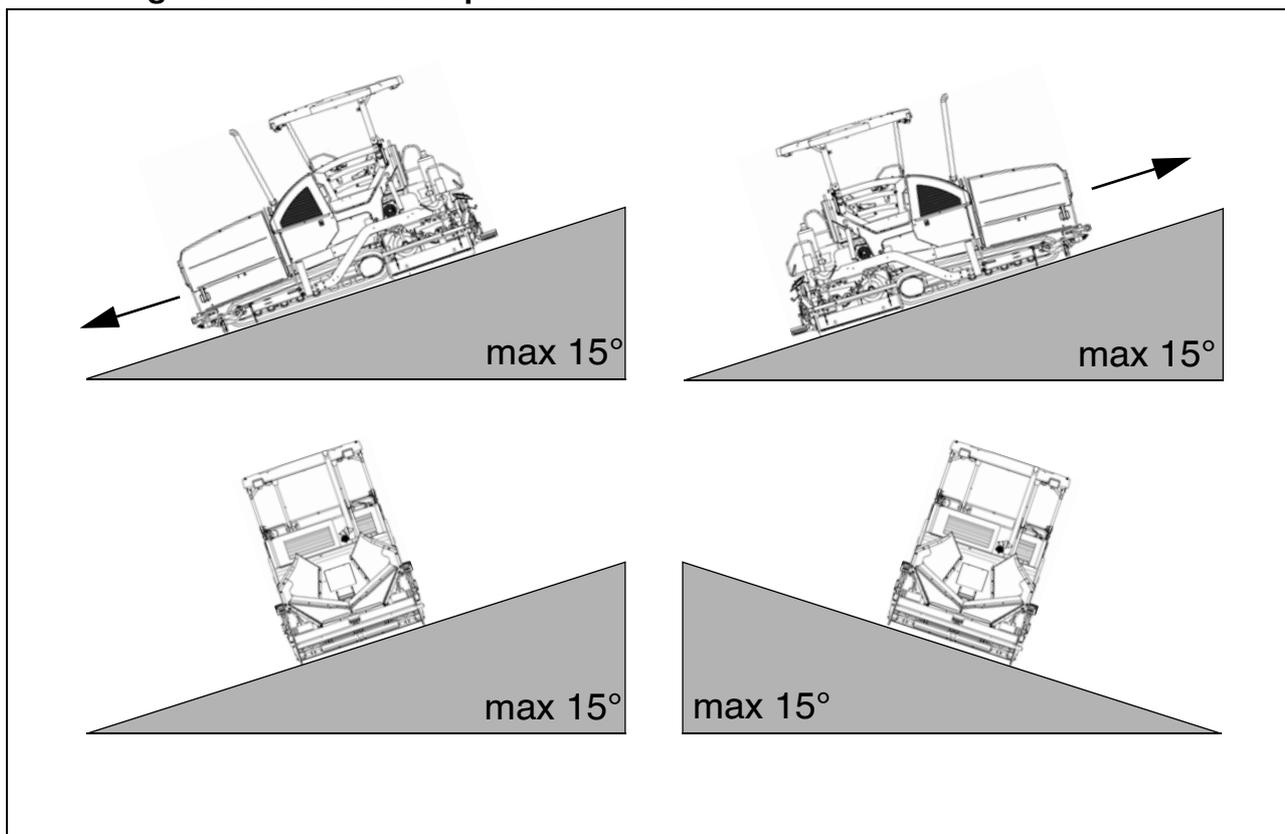
☞ ¡Antes de la operación de la máquina en posiciones inclinadas (rampas, pendientes, inclinación lateral) más allá del valor indicado debe consultarse el servicio técnico para su máquina!
