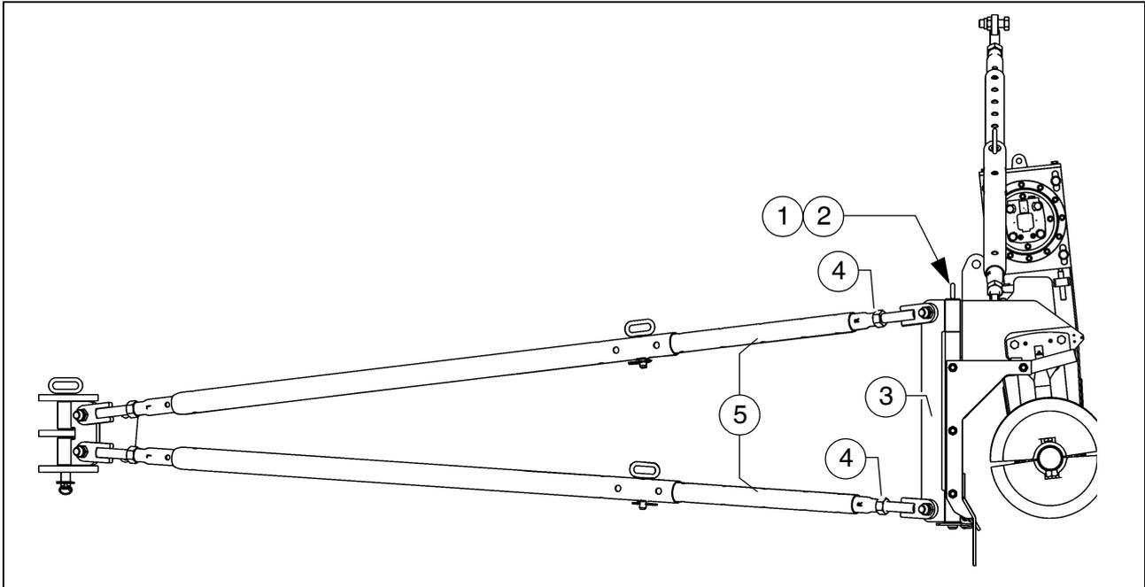
La altura de ajuste del tornillo sinfín puede efectuarse en las anchuras de trabajo grandes con arriostramiento fijado:
