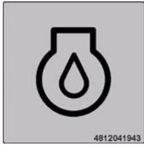
4812041943   | - <b>Aceite del motor</b><br>Posición del punto de llenado y de control.                |
