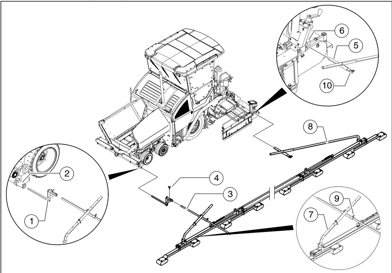
El Ski de remolque incluye un Ski móvil en varias articulaciones que se desliza en la superficie de referencia así como un sensor rotatorio que explica un alambre de referencia que se halla en el Ski.
