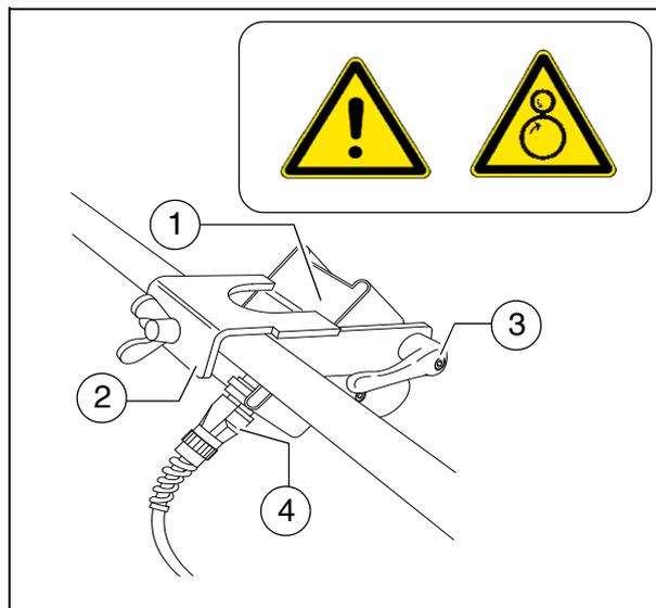
Los cables de conexión (4) se unen con las cajas de enchufe pertinentes en el soporte para el mando a distancia.
