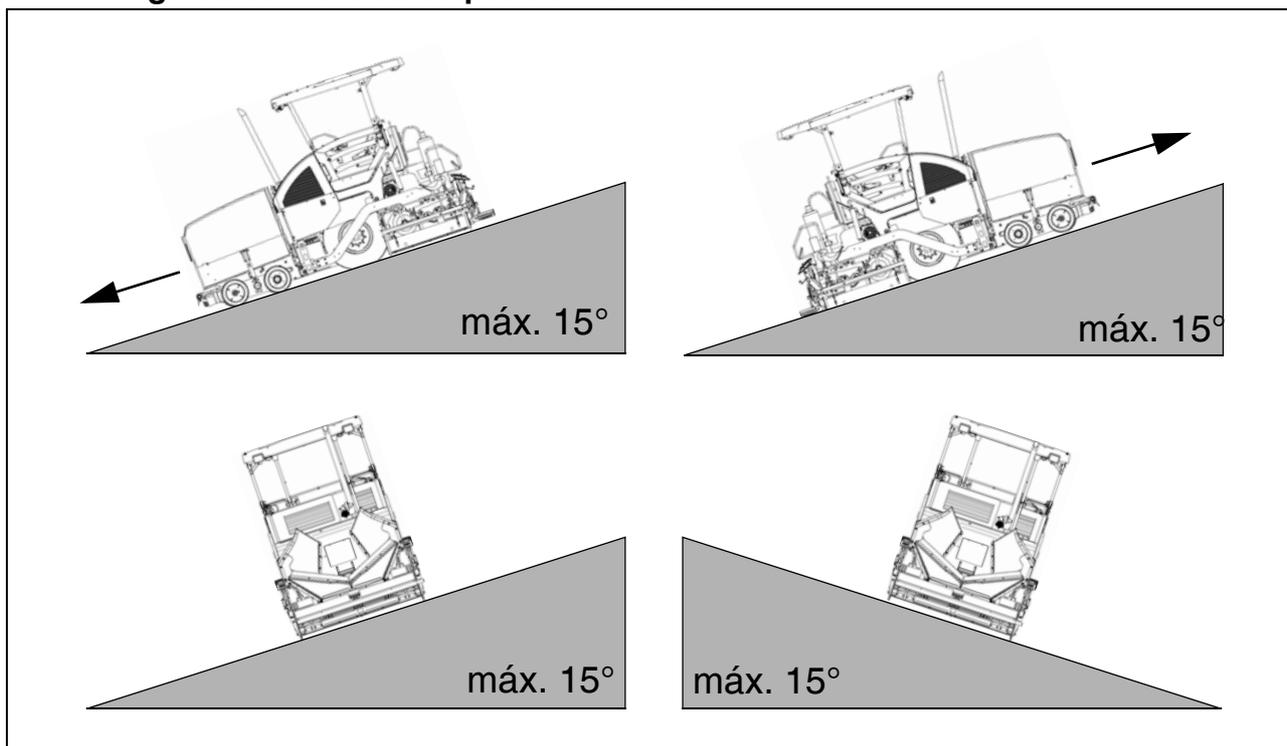
☞ ¡Antes de la operación de la máquina en posiciones inclinadas (rampas, pendientes, inclinación transversal) más allá del valor indicado debe consultarse el servicio técnico para su máquina!
