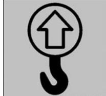
D990000225                 | <ul style="list-style-type: none"> <li><b>Точка подъёма</b><br/>Подъём машины разрешен только за эти точки строповки!</li> </ul>                             |
