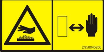
D956045200 | <ul style="list-style-type: none"> <li><b>Осторожно - горячие поверхности - опасность ожога!</b><br/>Горячие поверхности могут стать причиной тяжелых травм!<br/>Руки должны быть на безопасном расстоянии от опасной области!<br/>Используйте защитную одежду или средства защиты персонала!</li> </ul> |
