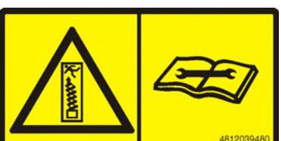
4812039480 | <ul style="list-style-type: none"> <li><b>Предостережение - элемент конструкции под нагрузкой пружины!</b><br/>Неквалифицированное исполнение работ может привести к тяжёлым травмам со смертельным исходом. Соблюдайте инструкцию по техобслуживанию!</li> </ul>                                        |
