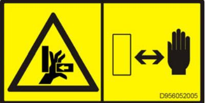
D956052005   | <ul style="list-style-type: none"> <li><b>Предостережение - опасность травмирования пальцев и рук подвижными, доступными деталями машины!</b><br/>В местах прижатия возможны тяжелые травмы с потерей частей пальцев и рук.<br/>Руки должны быть на безопасном расстоянии от опасной области!</li> </ul> |
