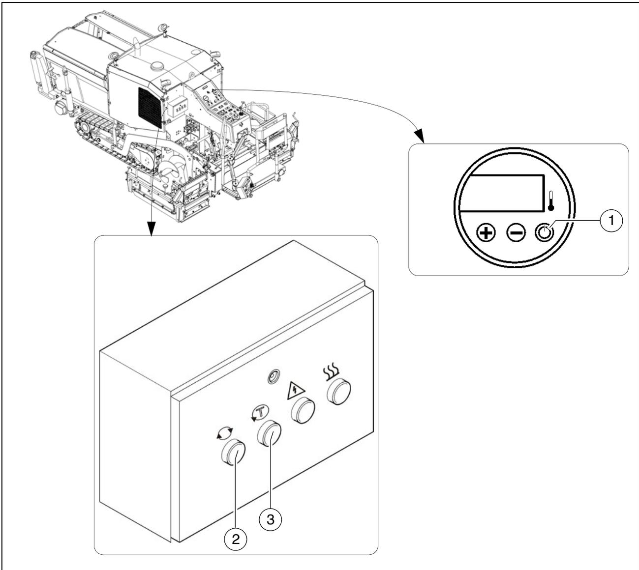
La verifica del funzionamento del controllo dell'isolamento deve essere eseguita ogni giorno prima di iniziare i lavori di stesa.
