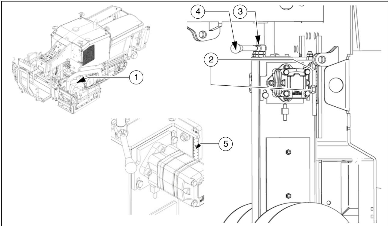
L'altezza della coclea di distribuzione (1) – misurata dal bordo inferiore – deve essere superiore di min. 50 mm (2 pollici) rispetto all'altezza di stesa del materiale, a seconda della miscela del materiale stesso.
