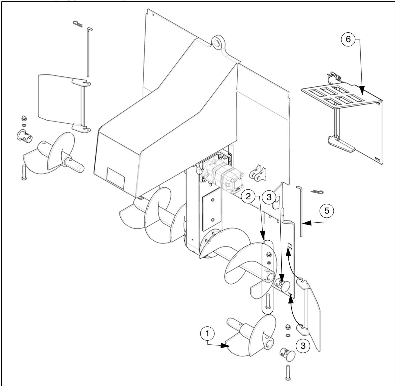
Per montare le prolunghesse delle coclee, sull'albero della coclea si monta un ulteriore segmento di coclea (1).
