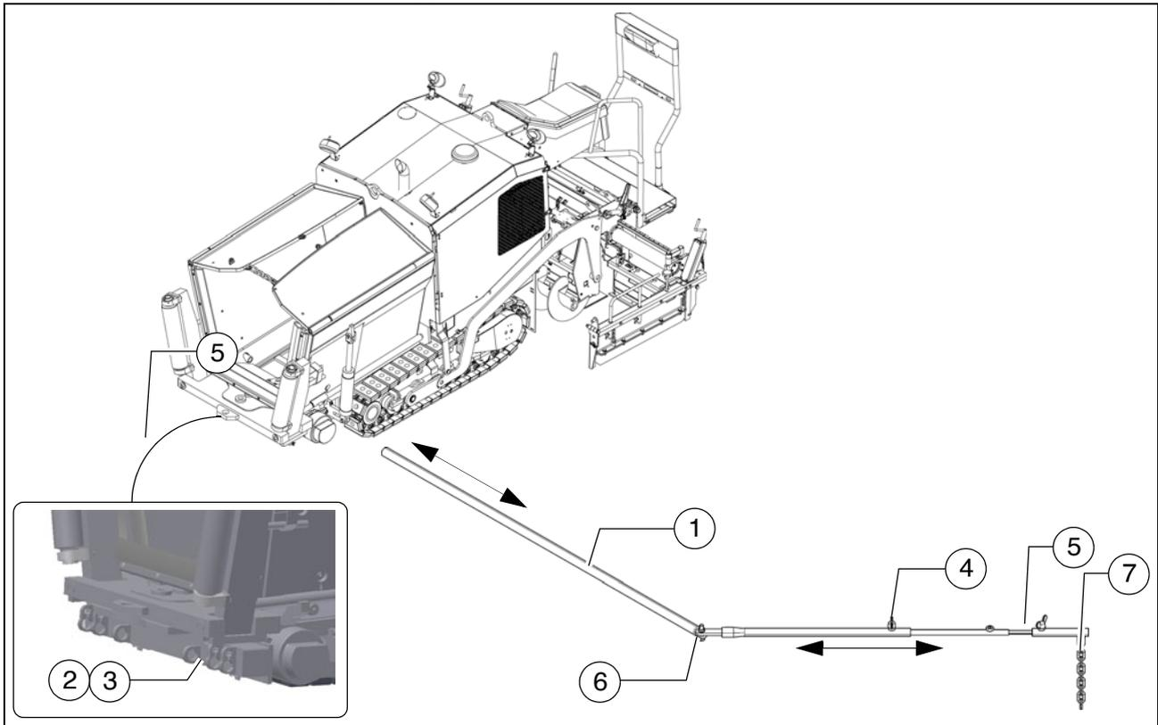
L'astina di livello serve da sussidio orientativo al conducente della macchina durante la stesa. Con l'astina di livello il conducente della macchina può seguire sul tratto stradale prestabilito un filo di riferimento teso o un'altra traccia.
