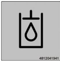
4812041941 | - <b>Hydrauliköl</b><br>Position der Einfüllstelle.                    |
