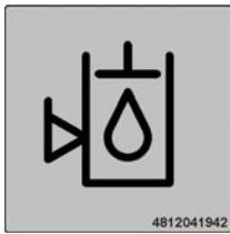
4812041942 | - <b>Hydraulikölstand</b><br>Position Kontrollstelle.                  |
