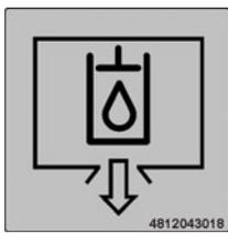
4812043018 | - <b>Hydrauliköl-Ablassstelle</b><br>Position der Ablassstelle.        |
