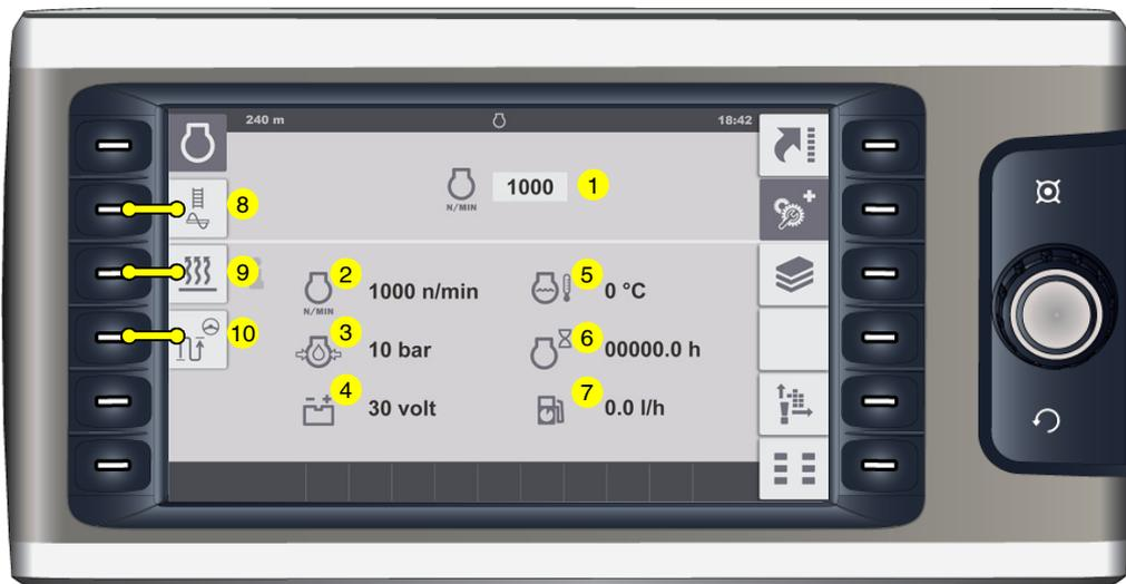
Menü zur Einstellung der Motordrehzahl und zur Abfrage verschiedener Messwerte des Antriebsmotors.
