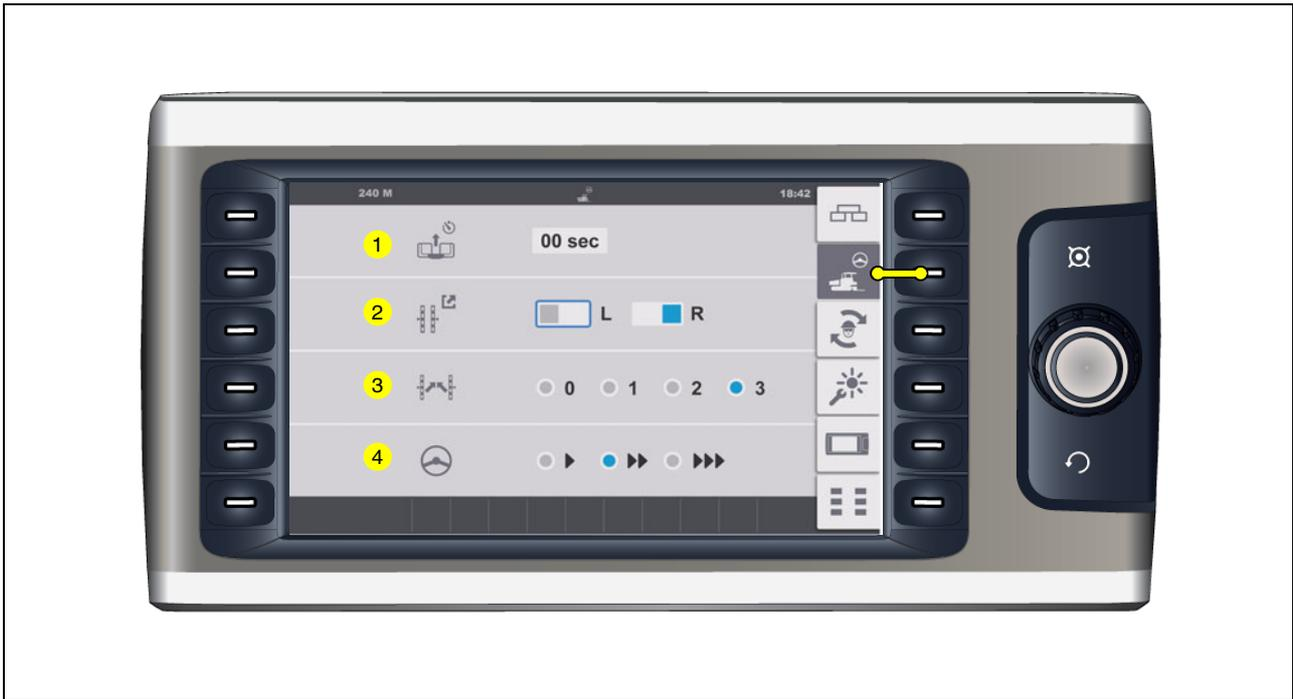
Menü zur Einrichtung von Maschinen- und Nivellier-Funktionen.
