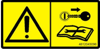
4812043096  | <ul style="list-style-type: none"> <li><b>Advarsel - før vedlikehold og reparasjoner skal drivmotoren slås av og tenningsnøkkelen trekkes ut!</b><br/>Løpende drivmotor eller innkoblede funksjoner kan føre til svært store personskader eller død!<br/>Slå av drivmotoren og trekk ut tenningsnøkkelen.</li> </ul>                                                                                                                                                        |
