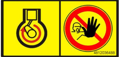
4812036488  | <ul style="list-style-type: none"> <li><b>Advarsel - fare fra drivmotor i gang!</b><br/>Dersom drivmotoren går kan det føre til svært store personskader eller død.<br/>Det er forbudt å åpne motorpanseret med drivmotoren i gang!</li> </ul>                                                                                                                    |
