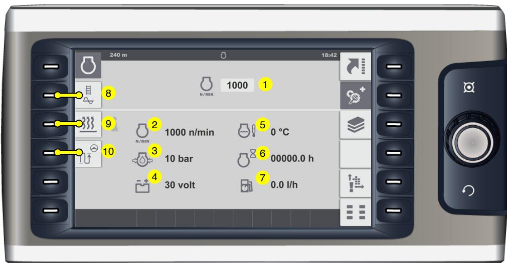
Meny for innstilling av motorturtallet og opphenting av ulike måleverdier fra drivmotoren.
