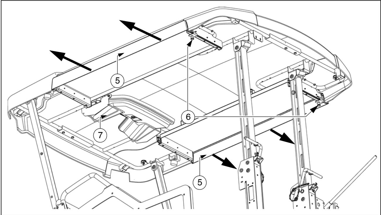
Til venstre og høyre på allværestaket befinner det seg en utskyvbar regn- og solskjerm (5) som beskytter føreren f.eks. når setekonsollen er skjøvet ut.
