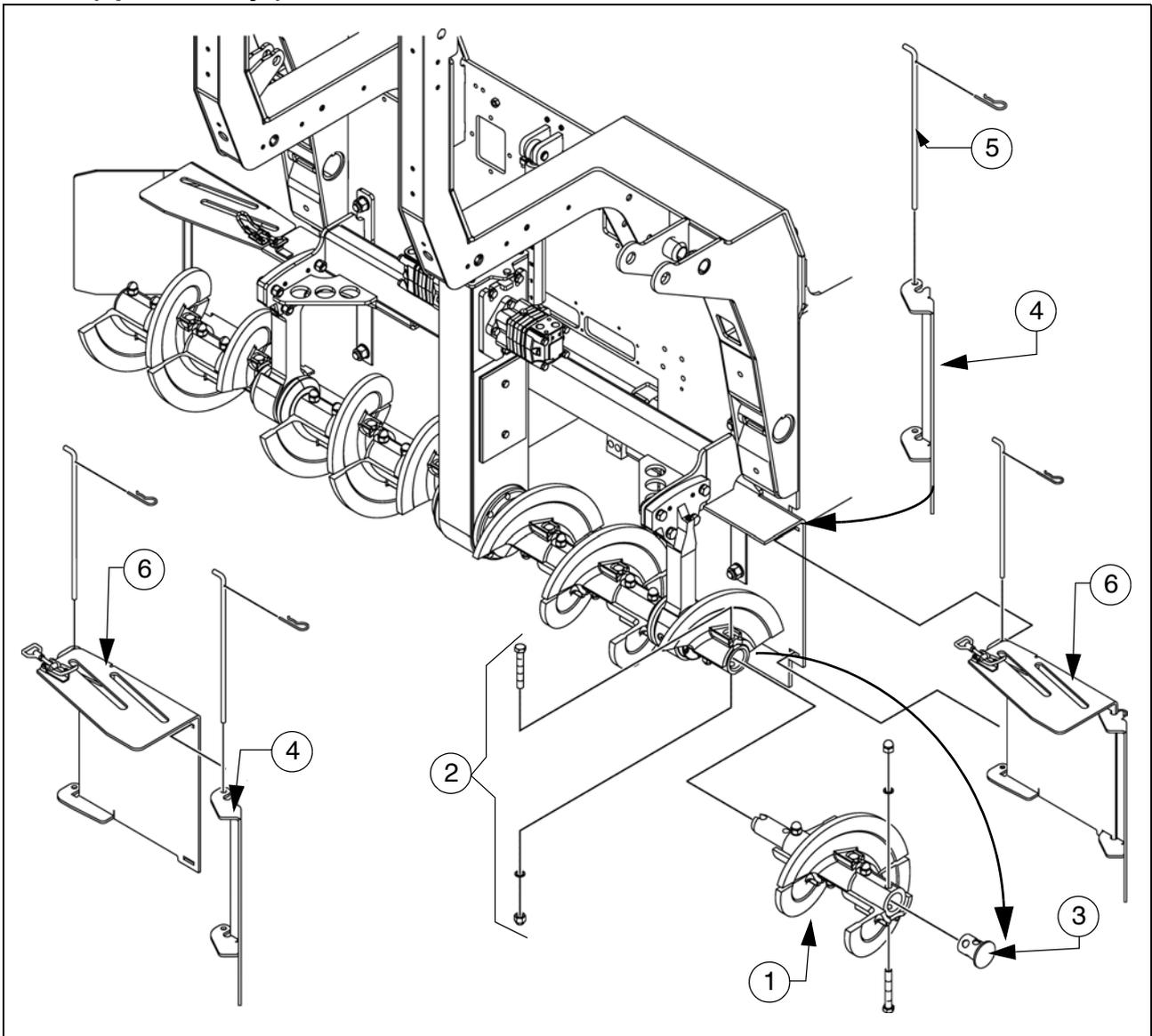
I forbindelse med montering av mateskrueforlengelser monteres et ekstra mateskrue-segment (1) på mateskrueakselen.
