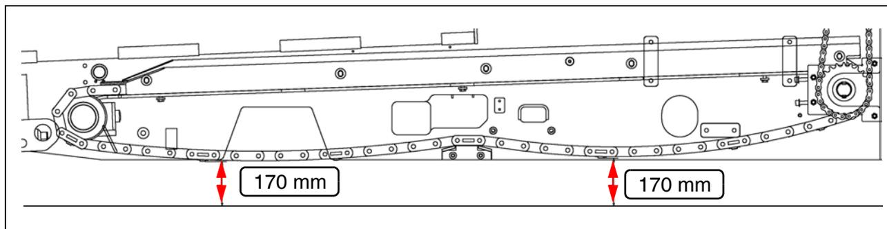
Ved korrekt strammet matebeltekjede henger underkanten av begge kjedenedhengene (foran og bak kjettingføringen) ca. 170 mm over underlaget.
