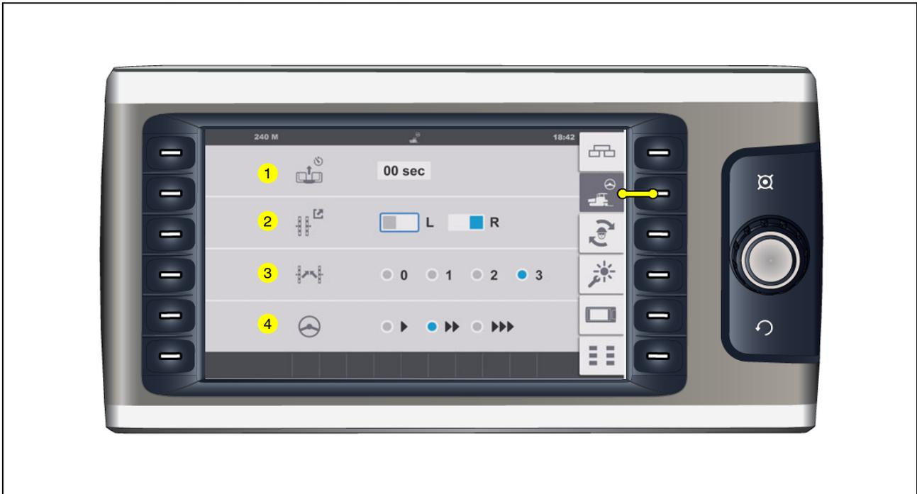
Meny for innretning av maskin- og nivelleringsfunksjoner.
