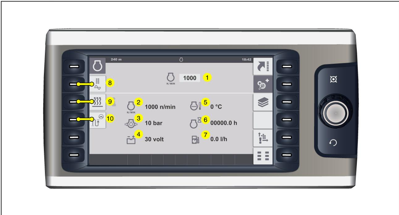
Meny for innstilling av motorturtallet og opphenting av ulike måleverdier fra drivmotoren.
