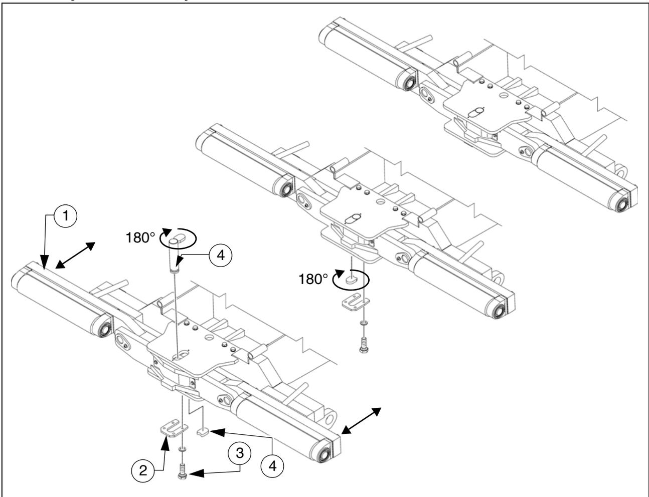
For tilpasning til ulike typer lastebiler kan skyverulltraversen (1) monteres i to posisjoner.
