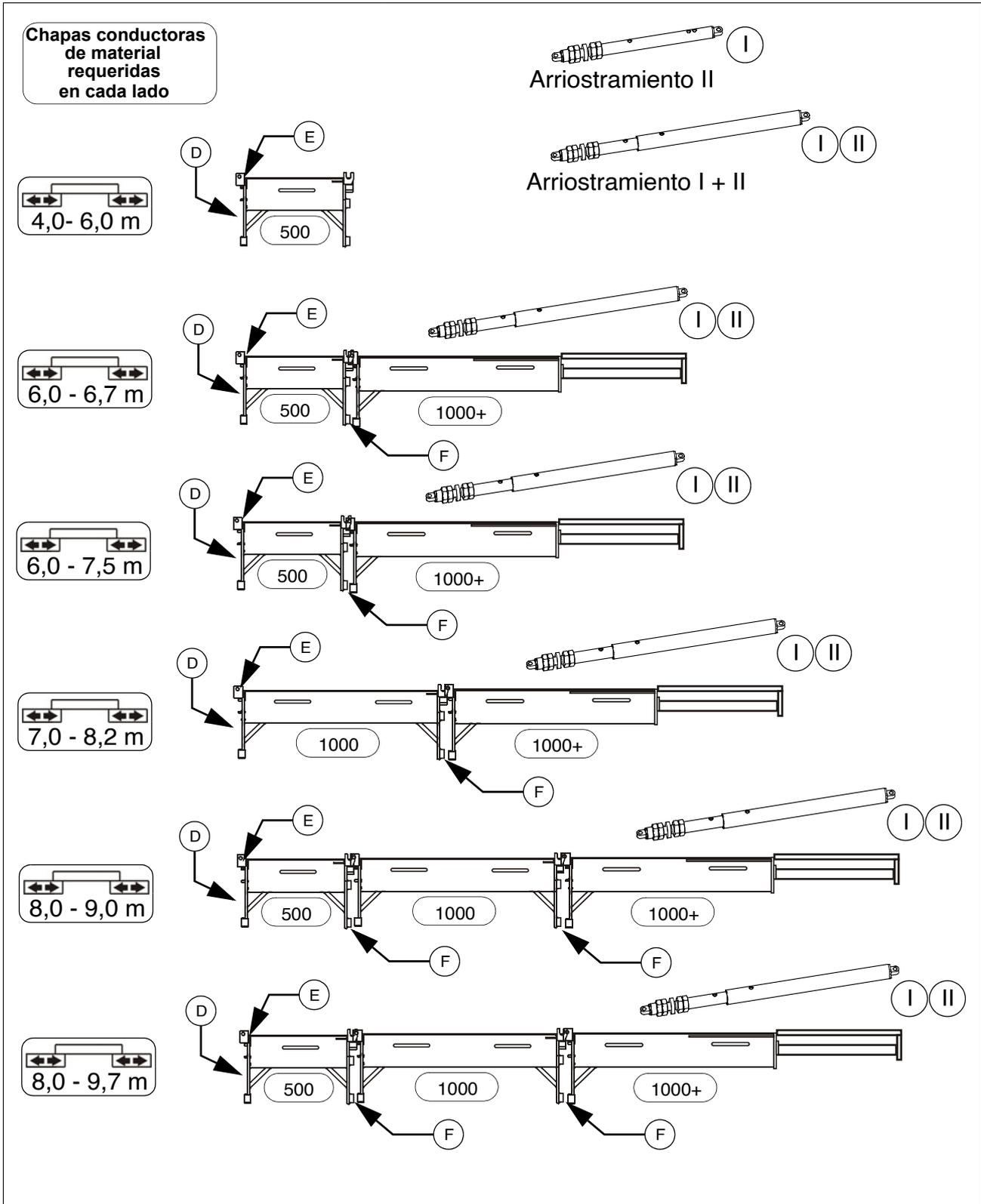
En cuanto se incorpora una chapa conductor de material ajustable, ¡debe montarse un arriostamiento!
