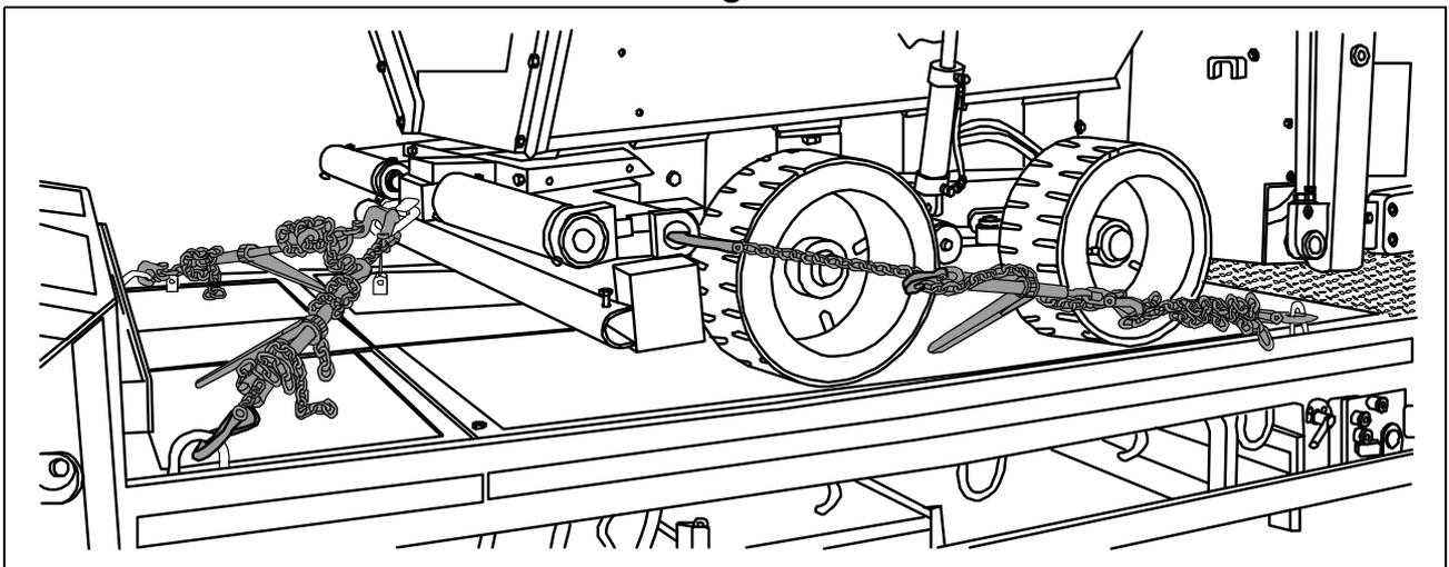
⚠ Die Sicherung vorn und seitlich ist durch Diagonalzurrn des Radfertigers durchzuführen. Hierbei sind die Anschlagpunkte am Fertiger sowie am Tieflader zu beachten. Die Zurrketten sind wie dargestellt anzubringen.
