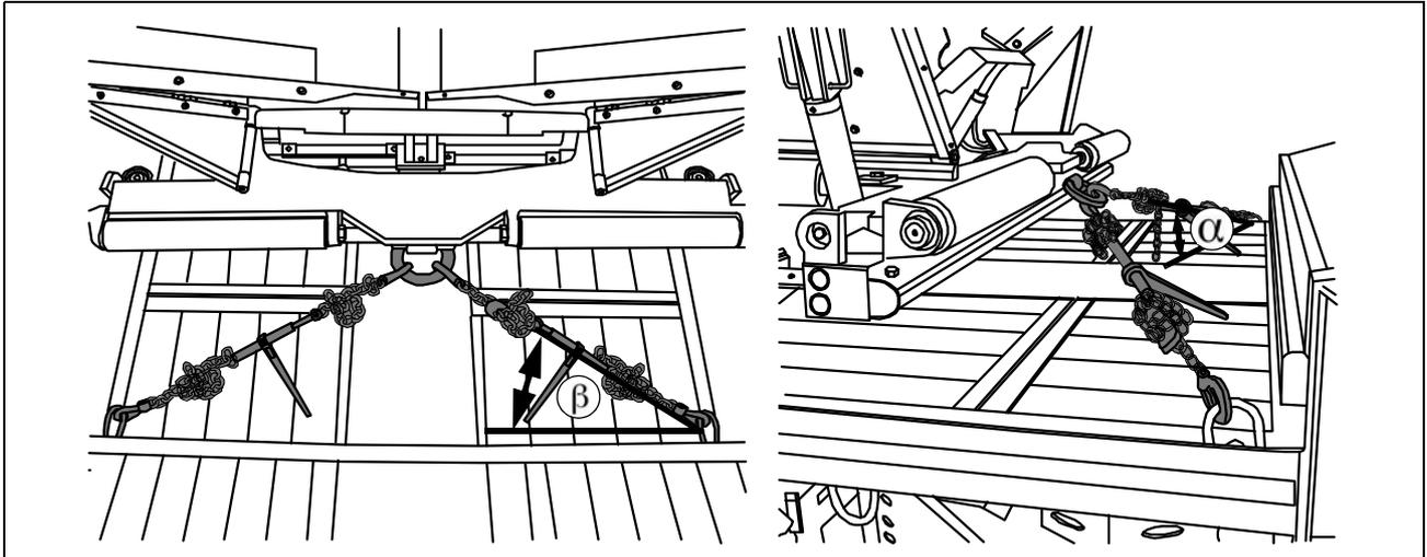
⚠ Die Sicherung vorne ist durch Diagonalzurrn des Fertigers durchzuführen. Hierbei sind die Anschlagpunkte am Fertiger sowie am Tieflader zu beachten. Die Zurrketten sind wie dargestellt anzubringen.
