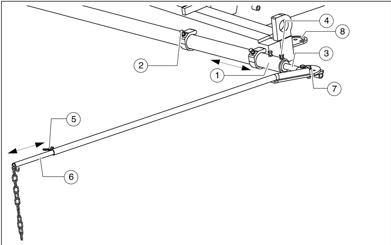
Der Peilstab dient dem Maschinenfahrer während des Einbaus als Orientierungshilfe. Mit dem Peilstab kann der Maschinenfahrer an der festgelegten Einbaustrecke einem gespannten Referenzdraht oder einer anderen Markierung folgen.
