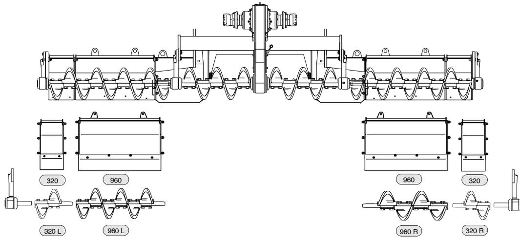
**Schneckenaufrüstung, Arbeitsbreite 5.70m**
