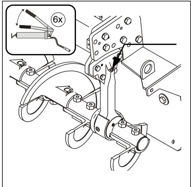
➡ Bei Schneckenerweiterung sollten bei der Erstabfettung der äußeren Lagerstellen die Außenringe etwas gelöst werden, um eine bessere Belüftung beim Abschmieren zu gewährleisten. Nach dem Abschmieren müssen die Außenringe wieder ordnungsgemäß befestigt werden.
