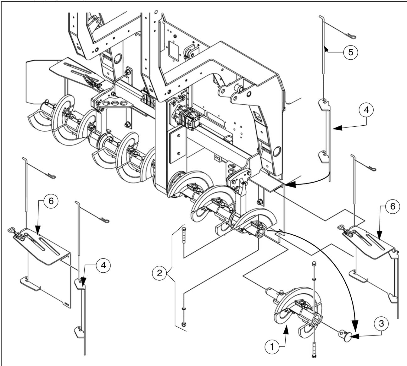
Para el montaje de las prolongaciones del tornillo sin fin se monta en el árbol del tornillo sin fin un segmento de tornillo sin fin (1) adicional.
