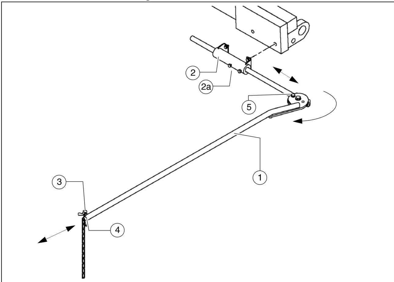
La varilla de sonda sirve como ayuda de orientación para el conductor de la máquina durante la pavimentación.
