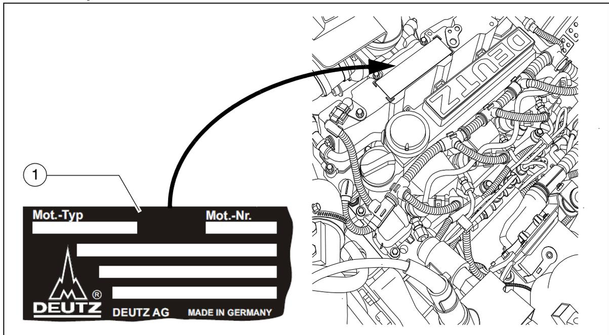
La placa de tipo del motor (1) se encuentra instalada en la parte superior del motor. En la placa se indican el tipo del motor, el número de serie y los datos del motor. En caso de pedir una pieza de repuesto, sírvase indicar el número de serie del motor.
