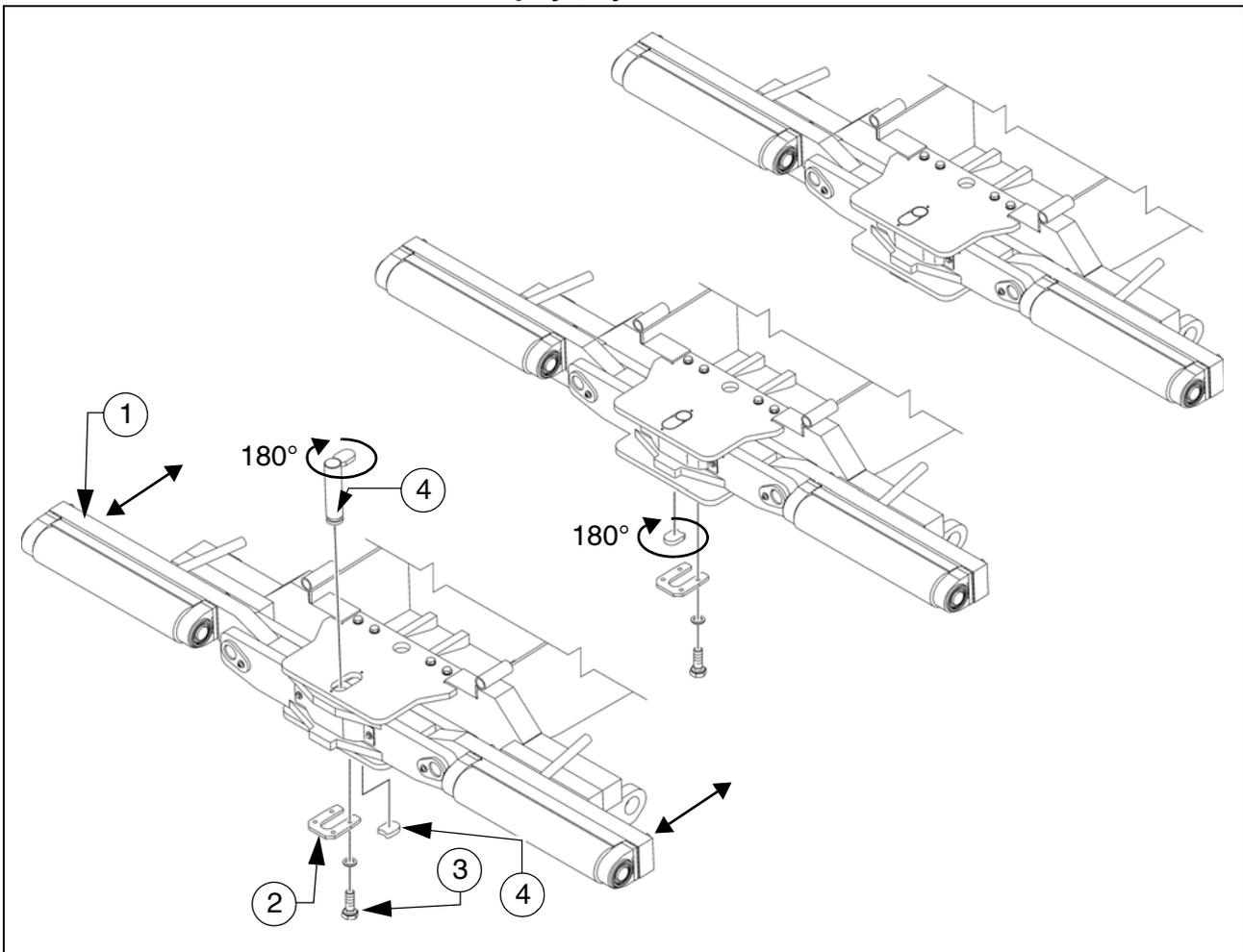
Para la adaptación a diferentes tipos constructivos de camión, puede trasladarse el travesaño de rodillos de empuje (1) en dos posiciones.
