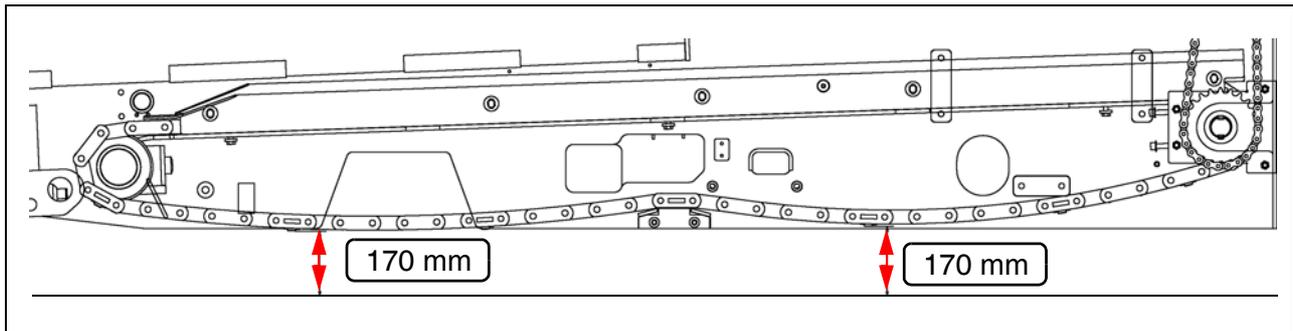
En caso de una cadena de rejillas tensada correctamente, los cantos inferiores de ambas flechas de cadena (delante y detrás de la guía de cadena) se encuentran unos 170 mm sobre el suelo.
