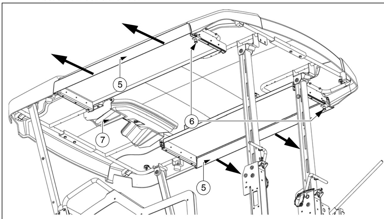
A la izquierda y a la derecha en el techo de protección se encuentra una protección extensible (5) que ofrece al conductor protección en caso de la consola de asiento extendida.
