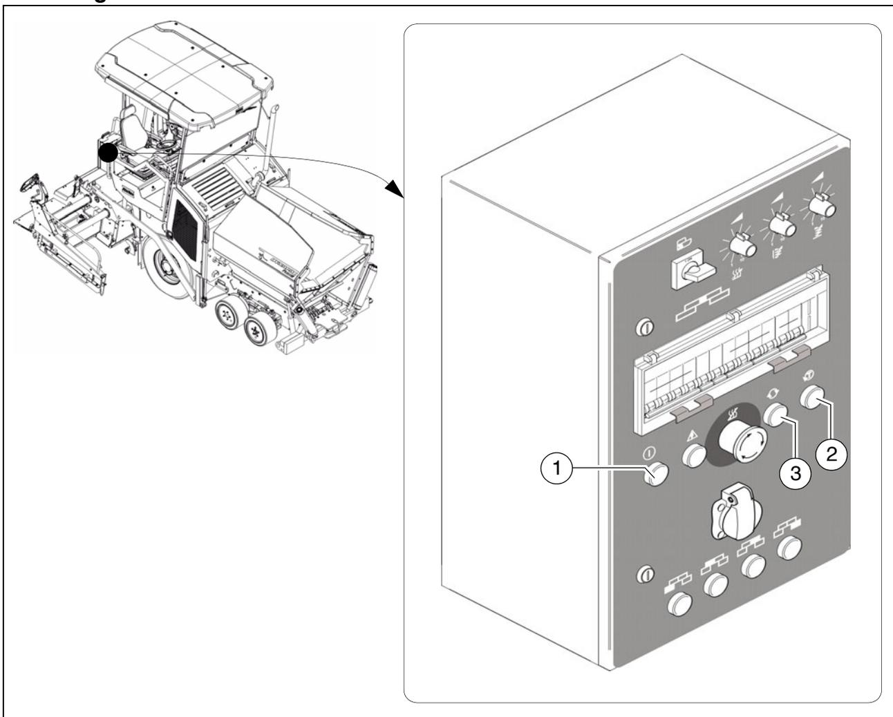
La comprobación del funcionamiento de la medida protectora del control del aislamiento debe efectuarse diariamente antes del comienzo del trabajo.
