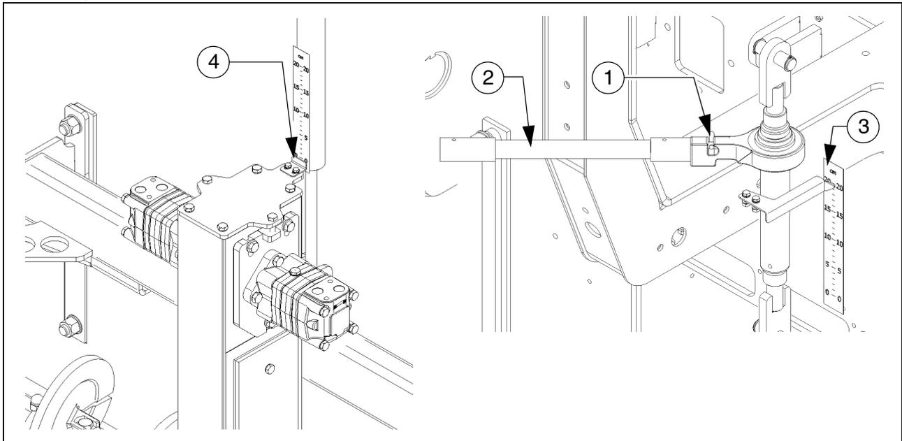
El tornillo distribuidor debe encontrarse a una altura mínima de 50 mm (2 pulgadas) por encima de la superficie de pavimentación (medido desde el borde inferior del tornillo) y dependiendo de la mezcla de material.
