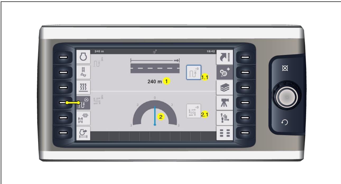
Menü zur Abfrage und zum Reset der aktuellen Einbaustrecke sowie zur Anzeige der Lenküberwachung und zum Reset der Lenküberwachung-Referenz.
