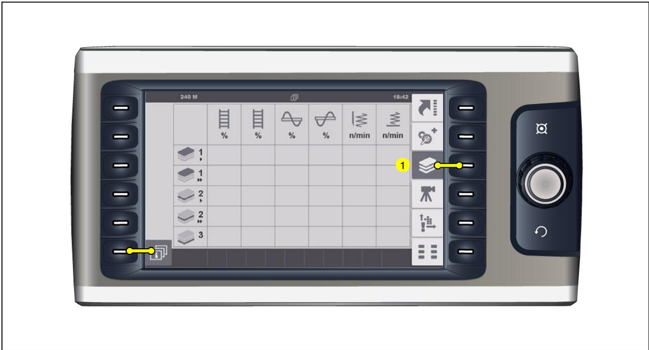
Menü zur Ansicht der nach Schichtdicken-Parameter hinterlegten Drehzahlen für alle Förder- und Verdichtungselemente.
