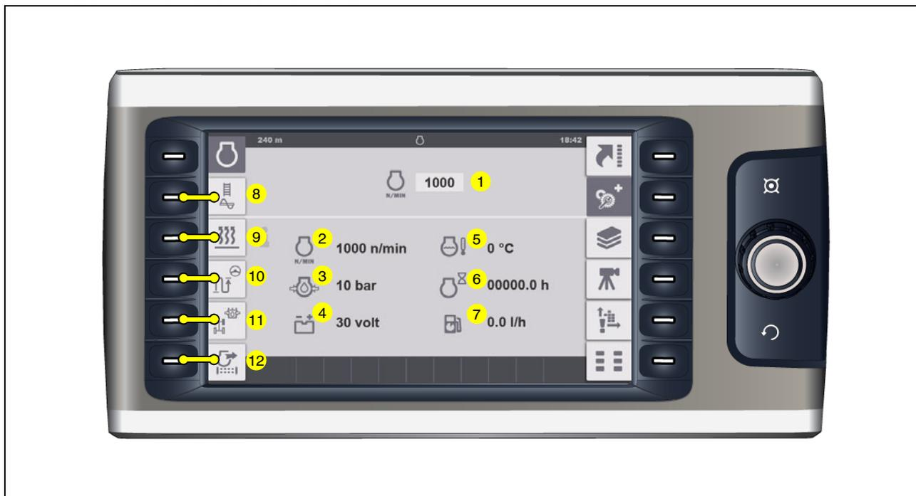
Menu de réglage du régime du moteur diesel et de consultation de différentes valeurs de mesure du moteur d'entraînement.
