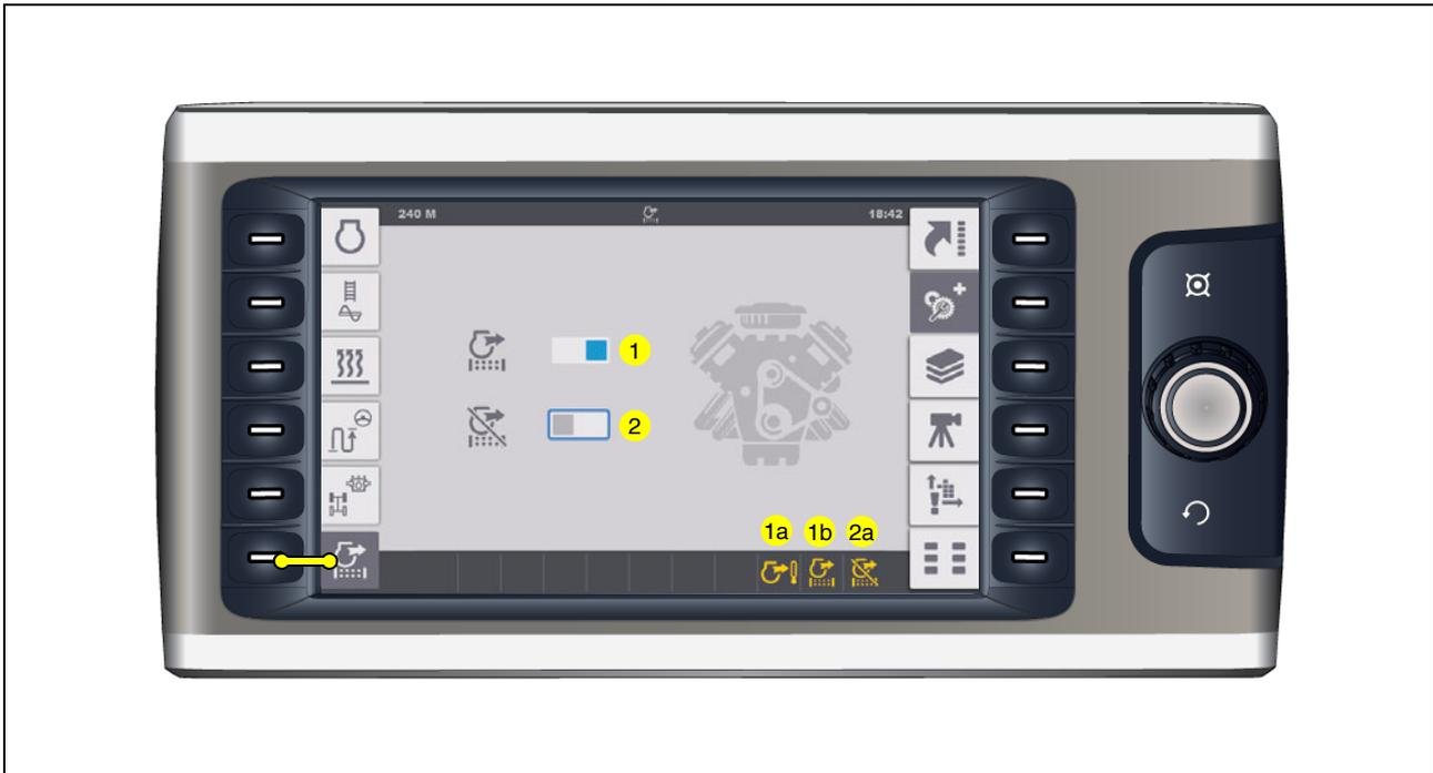
Menu pour le déclenchement d'une régénération de filtre actif nécessaire et le blocage de la régénération automatique du filtre.
