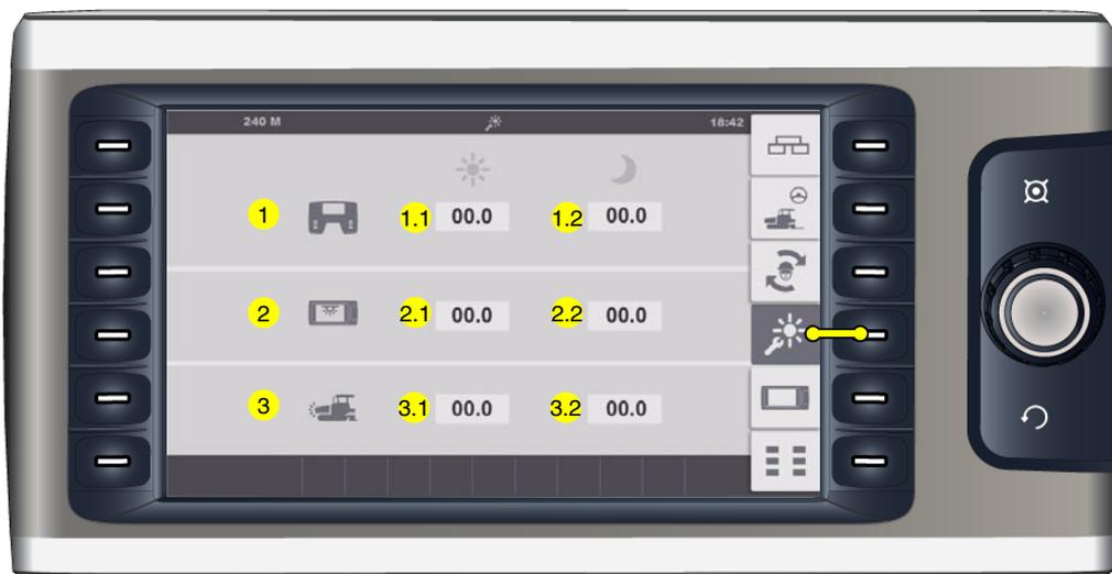
Menu de paramétrage de l'intensité lumineuse de différents éléments de commande.
