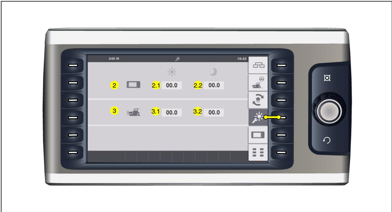
Menú para ajustar la intensidad luminosa de diferentes elementos de manejo.
