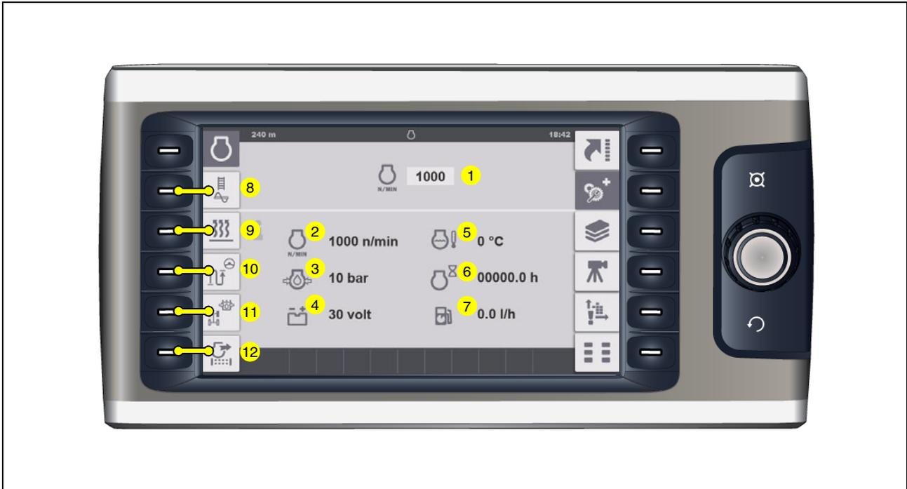
Menú para el ajuste de las revoluciones del motor y para consultar diversos valores de medición del motor de accionamiento.
