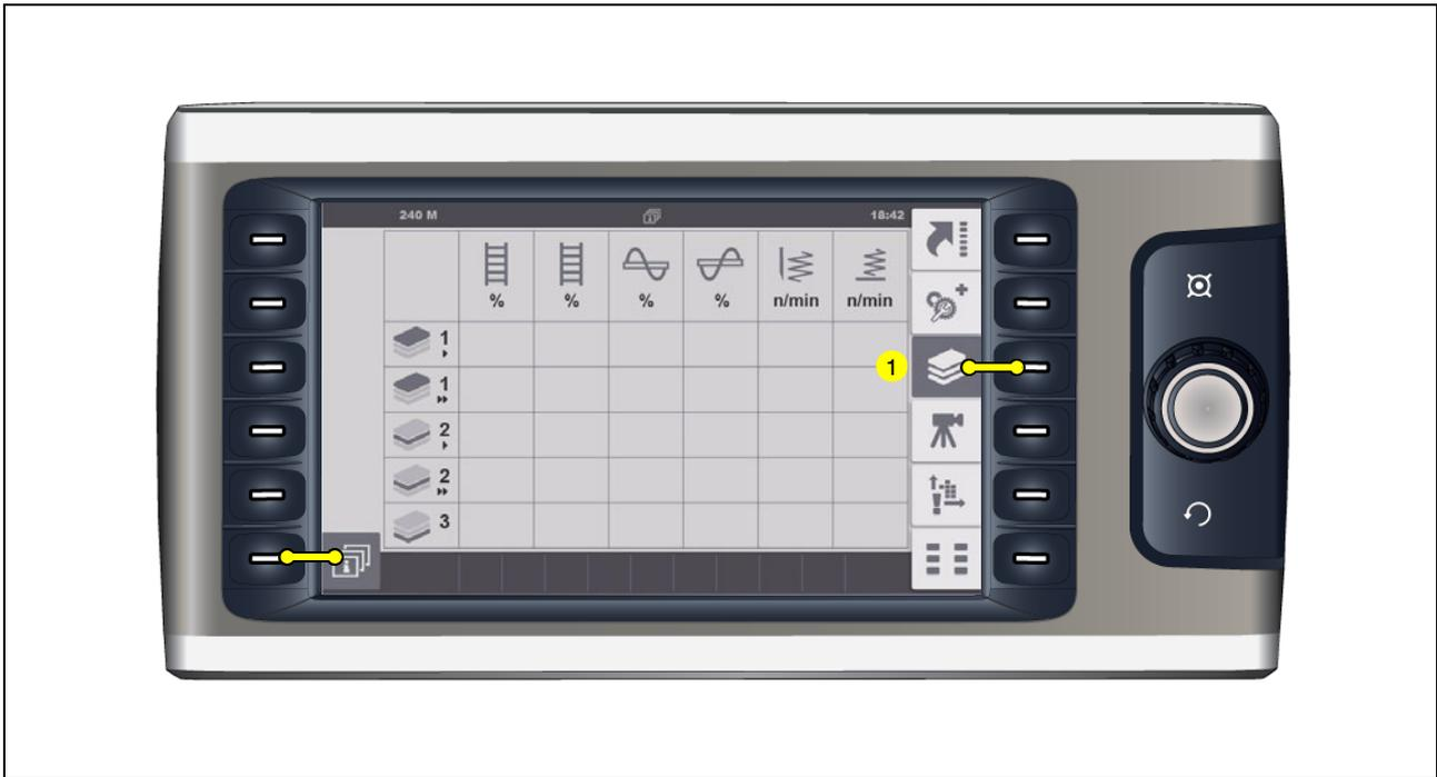
Menú para ver los números de revoluciones archivados según los parámetros de espesores de capa para todos los elementos de transporte y de compresión.
