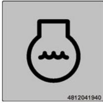
4812041940   | - <b>Acqua di raffreddamento del motore</b><br>Posizione del punto di rifornimento e di controllo. |
