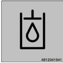
4812041941  | - <b>Olio idraulico</b><br>Posizione del punto di rifornimento.                                    |
