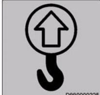
D990000225   | <ul style="list-style-type: none"> <li>- <b>Точка подъёма</b><br/>Подъём машины разрешен только за эти точки строповки!</li> </ul>                             |
