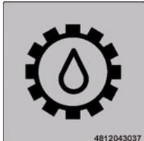
4812043037 | <ul style="list-style-type: none"> <li>- <b>Трансмиссионное масло</b><br/>Расположение мест заполнения и контроля.</li> </ul> |
