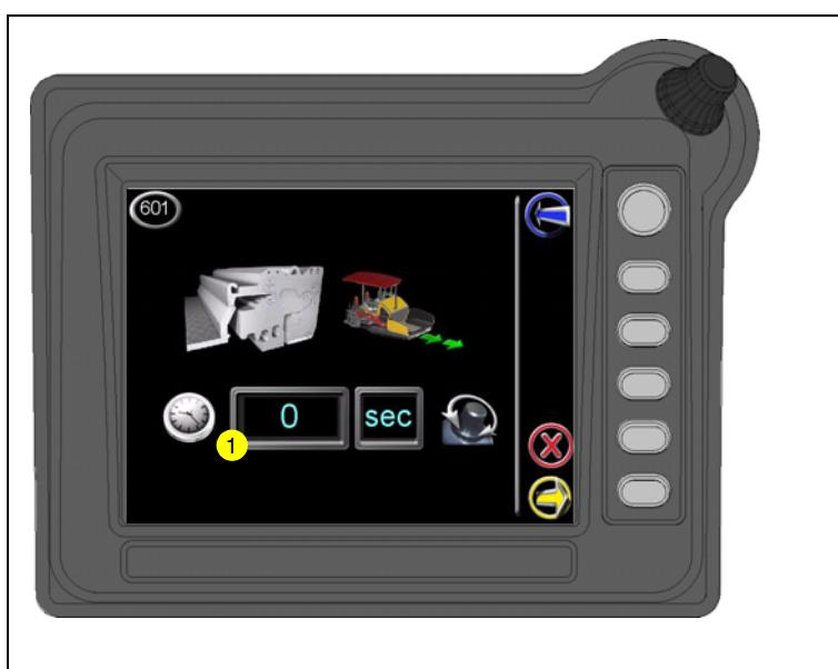
При отклонении рычага хода, функция плавающего режима выглаживающей плиты включается только после истечения времени заданной задержки.
