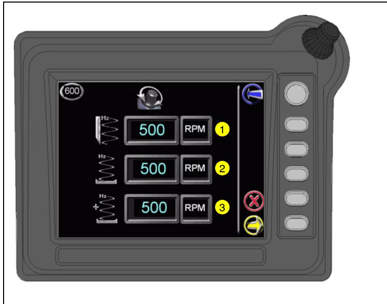
Диапазон регулировки трамбовочного бруса, вибрации и вспомогательного уплотнителя зависит от типа выглаживающей плиты. (смотри Руководство по выглаживающей плите).
