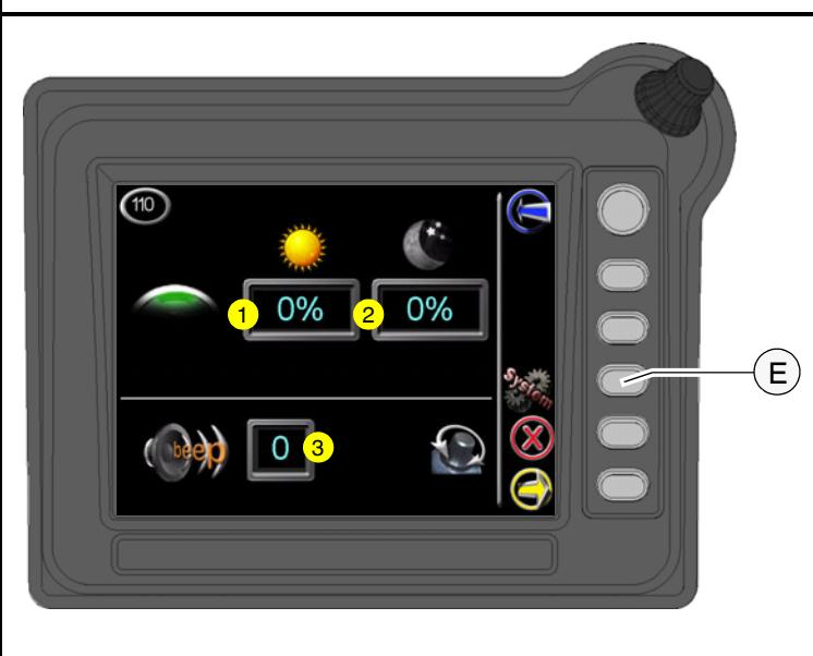
При включении рабочего освещения система автоматически переходит к настройкам для темного времени суток.
