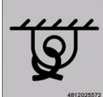
4812025572  | <ul style="list-style-type: none"> <li>- <b>Точка закрепления</b><br/>Крепление машины разрешено только в этих точках строповки!</li> </ul>                    |
