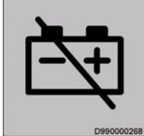
D990000268 | <ul style="list-style-type: none"> <li>- <b>Разъединительный выключатель аккумуляторов</b><br/>Позиция разъединительного выключателя аккумуляторов.</li> </ul> |
