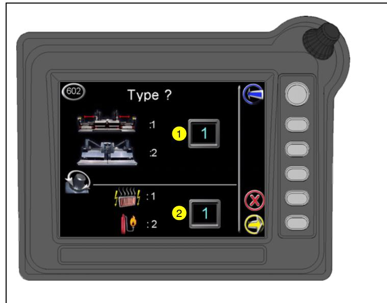
Если к асфальтоукладчику подсоединяются различные типы выглаживающих плит, следует выполнить соответствующую настройку!
