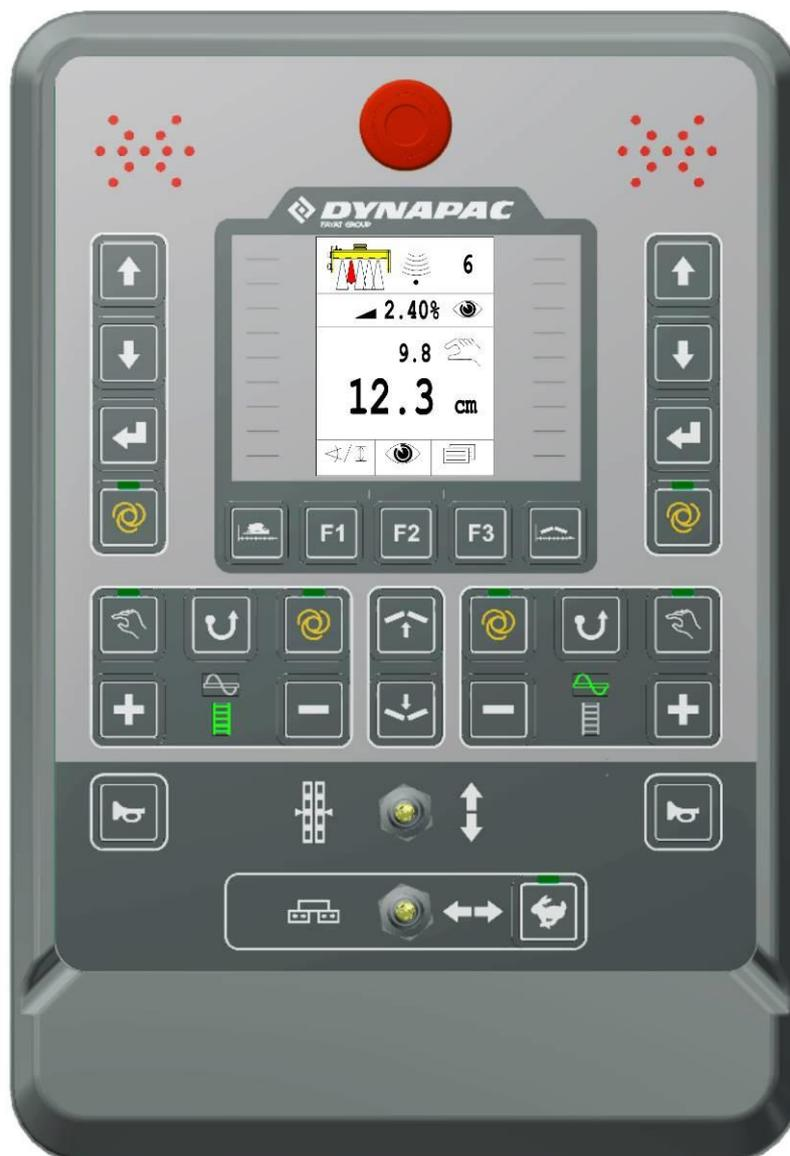
Die Fernbedienung beinhaltet alle zur Bedienung des Systems notwendigen Tasten, einige Funktionslampen, sowie ein 3,5" TFT - Display an dem jederzeit der aktuelle Status des Systems abgelesen werden kann.
