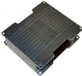
Le Screed-Controller Dynapac évalue les capteurs suivants montés dans et sur la table et envoie les valeurs de mesure à la commande de niveau supérieur du tracteur.
