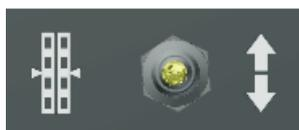
L'interrupteur à bascule déplace la table dans la position de travail souhaitée.
