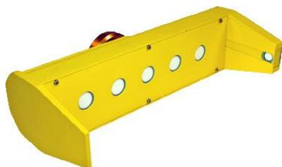
Le capteur Sonic-Ski® plus *SKIS-1500* sert à la mesure de distances et emploie cinq capteurs à ultrasons. Un sixième capteur sert à la compensation de température. Avec le palpage de sol, une moyenne est calculée à partir des valeurs de mesure des cinq capteurs à ultrasons du Sonic-Ski® plus.
