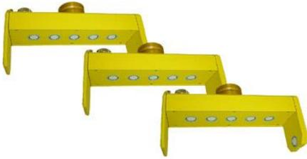
Le Big Sonic-Ski® emploie le principe de calcul de moyenne que l'on connaît déjà du Sonic-Ski® plus . Pour cela on répartit habituellement trois capteurs (par ex. 3x Sonic-Ski® plus) sur la longueur de la machine - ou au-delà, moyennant un dispositif mécanique adéquat.
