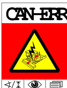
Origine : la liaison entre le Screed-Controller et le système de commande de niveau supérieur est interrompue.
