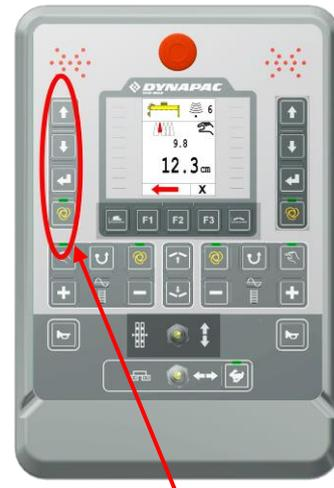
Si, les préalables décrits étant remplis, une touche quelconque du bloc de nivellement gauche est actionnée, l'affichage de la télécommande du côté droit affiche le nivellement pour le côté gauche.
