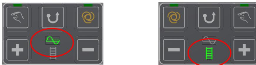
В остальном система управления шнеком подачи и конвейером полностью идентична. Меню появится только в случае, если предварительно была нажата кнопки + или -.
