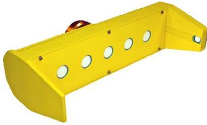
Датчик Sonic-Ski® plus SKIS-1500 - это измерительный датчик расстояния, который работает с пятью ультразвуковыми датчиками. Шестой датчик предназначен для температурной компенсации. При отслеживании поверхности грунта формируется среднее значение на основе сигналов пяти ультразвуковых датчиков Sonic-Ski® plus.
