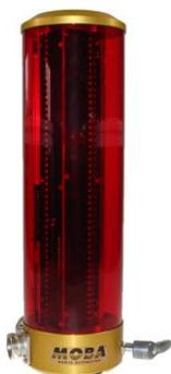
Пропорциональный лазерный приемник *LS-3000* – это измерительный датчик расстояния, который работает со всеми обычными ротационными лазерами, как например, с красными излучателями (гелий, неон) и инфракрасными излучателями. Он используется для строительства площадок и т.п. и оборудован приемником с диапазоном приема 29 см.
