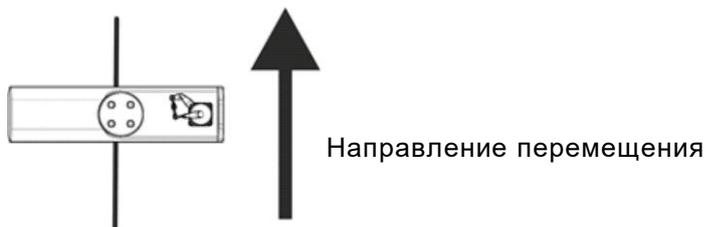
Чтобы трос проходил в правильном направлении под головками датчика Sonic-Ski® plus, датчик следует установить с обеих сторон так, как показано на изображении датчика, т.е. в обоих случаях разъем должен быть направлен влево (по направлению перемещения машины).
