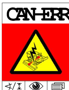
Причина: Прервана коммуникация между контроллером выглаживающей плиты (Screed Control) и системой управления высшего уровня.
