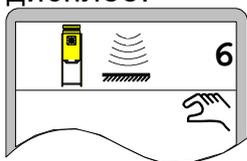
3) Переместите выглаживающую плиту в рабочее положение для калибровки на ноль с помощью кнопок ВВЕРХ / ВНИЗ или тумблера на пульте дистанционного управления.
