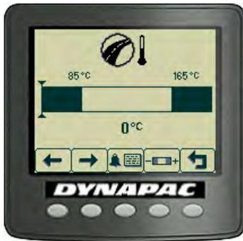
Fig. Schermata Temperatura asfalto
