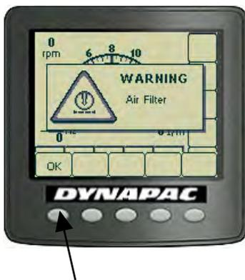
Quando viene attivato un allarme macchina, esso viene visualizzato sul display accompagnato da un testo di avvertenza che lo descrive.
