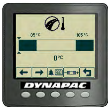
Fig. Pantalla de la temperatura del asfalto
