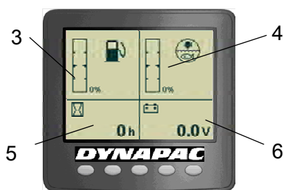
Fig. Statusbild 3. Bränslenivå 4. Vattennivå 5. Drifftimräknare 6. Voltmätare
