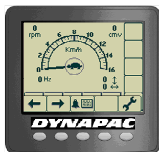
图：显示屏在中间显示选项（龟速、钢轮空转、车轮空转和疾速）
