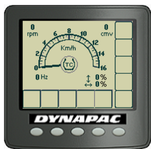
图：显示屏显示 TC ( 防尾旋 ) 是否启用/禁用。
