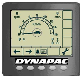
Fig. L'écran affiche la sélection au milieu (tortue, rotation du cylindre, rotation des roues ou lièvre).
