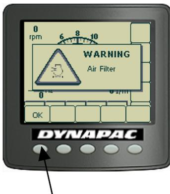
Lorsqu'une alarme de défaillance machine se déclenche, elle apparaît sur l'écran, accompagnée d'un texte d'avertissement décrivant cette alarme.
