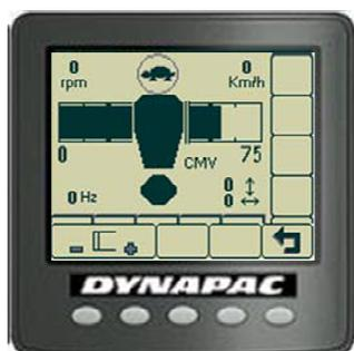
Le système ABC arrête ensuite les vibrations et avertit l'opérateur de continuer le compactage en diminuant le réglage de l'amplitude des vibrations ou, dans le cas où la fréquence de vibration est variable, en réduisant celle-ci.
