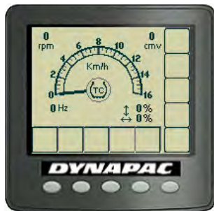
Εικ. Στην οθόνη υποδεικνύεται εάν το σύστημα TC (Σύστημα ελέγχου περιστροφής τροχών) είναι ενεργοποιημένο ή απενεργοποιημένο
