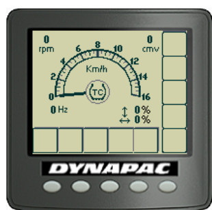
Fig. Il display mostra se il TC (anti-rotazione) è attivato o disattivato
