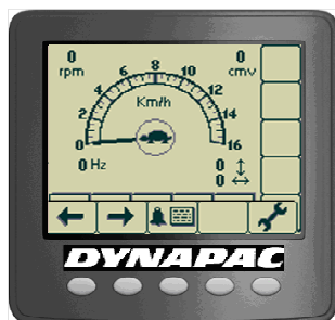
Fig. Il display mostra al centro la selezione (tartaruga, rotazione tamburo, rotazione ruota o lepre).
