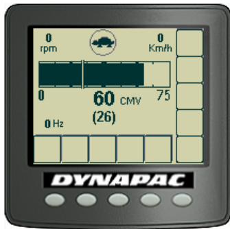
Fig. Display del compattometro (display CMV)
