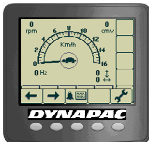
Fig. Displayet viser valget i midten (skilpadde, valsen spinner, hjul spinner eller hare).
