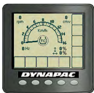
Fig. Displayet viser om TC (antispinn) er aktivert eller deaktivert
