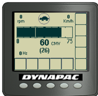
Rys. Ekran pomiaru zagęszczenia (CMV)
