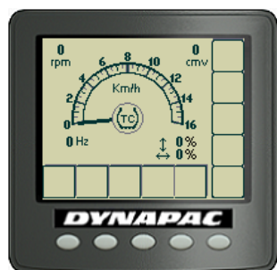
Рис. На дисплее показано включенное/отключенное состояние противобуксовочной системы
