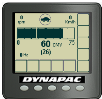
Рис. Дисплей измерителя уплотнения
