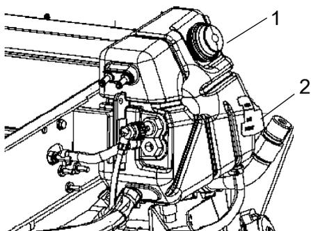
**Fig. Depósito de expansión**
