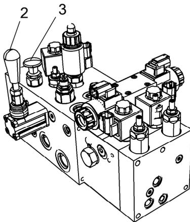
**Fig. Bloque de válvulas, compartimento del motor**
