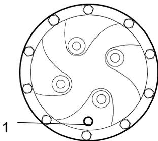
**Fig. Planetario / posición de desagüe**
