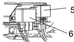
**5. Relé del motor de arranque, 50A**
