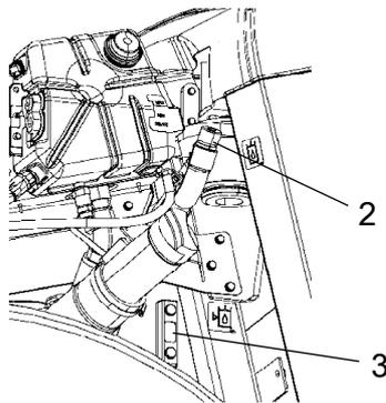
**Fig. Depósito hidráulico**
