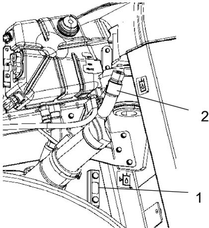
**Fig. Depósito hidráulico**
