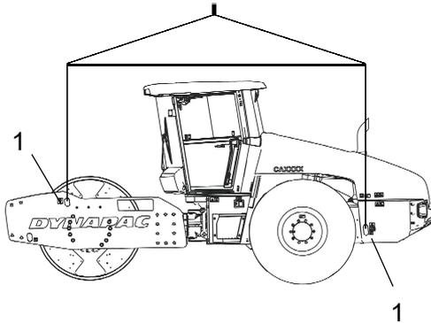
**Fig. Rodillo preparado para su elevación**
