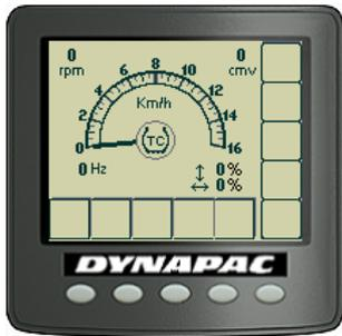
**Fig. En la pantalla se muestra si se ha activado o desactivado el TC (antideslizamiento)**
