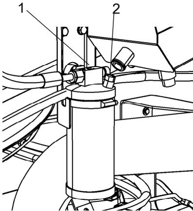
**Fig. Filtro de secado del compartimento del motor**
