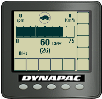
Şekil. Sıkıştırma ölçeri gösterimi (CMV gösterimi)
