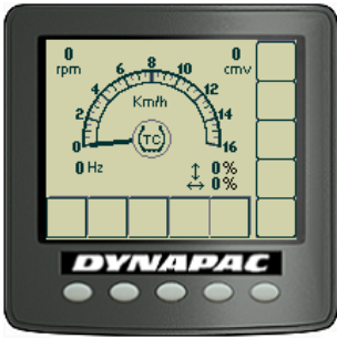
Şekil. Ekranda TC'nin (Anti-Patinaj) etkin ya da devre dışı olduğu gösterilir.
