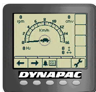
Фиг. Дисплеят показва избора в средата (костенурка, въртене на барабана, въртене на колелото или заек).
