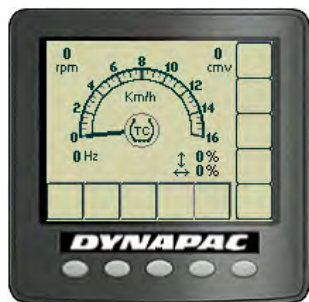
Фиг. Дисплей показва дали ТС (против буксуване) е активиран или изключен
