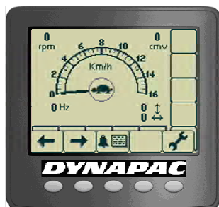
Afb. De geselecteerde versnelling (schildpad, wals-spin, wielspin of haas) wordt midden in het display weergegeven.
