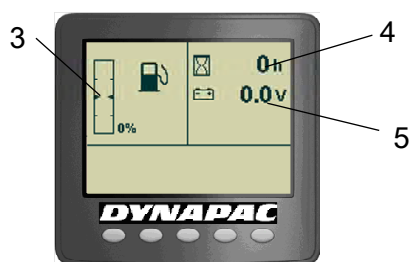
Afb. Statusscherm 3. Brandstofpeil 4. Urenteller 5. Voltmeter
