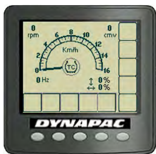
Obr. Displej zobrazuje, či je TC (systém proti pretočeniu) aktivovaný alebo odpojený
