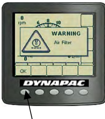
Al activarse una alarma de máquina, ésta se mostrará en la pantalla acompañada de un texto de advertencia en el que se describe la alarma.
