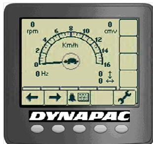
Fig. En la parte central de la pantalla se muestra la selección (líbre, deslizamiento del tambor, deslizamiento de ruedas o tortuga).
