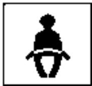
A menos que se utilice el cinturón de seguridad, una imagen de la advertencia aparecen en la pantalla y un zumbador de advertencia suena para alertar al conductor a utilizar el cinturón de seguridad.
