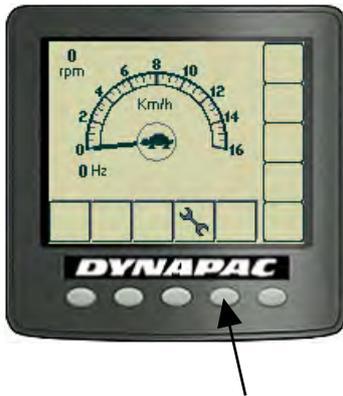
Se muestra un símbolo de mantenimiento en la parte inferior de la pantalla.
