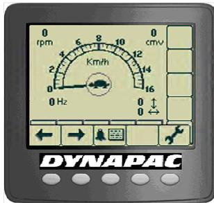
Fig. En la parte central de la pantalla se muestra la selección (liebre, deslizamiento del tambor, deslizamiento de ruedas o tortuga).
