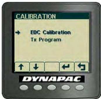
**"CALIBRATION"** (CALIBRACIÓN) - Para el personal de mantenimiento exclusivamente, requiere una contraseña.
