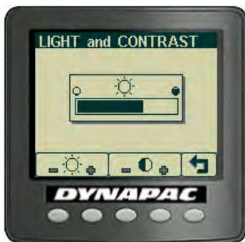
Ajuste de la luz y contraste de la pantalla, incluyendo el brillo de la luz del panel.
