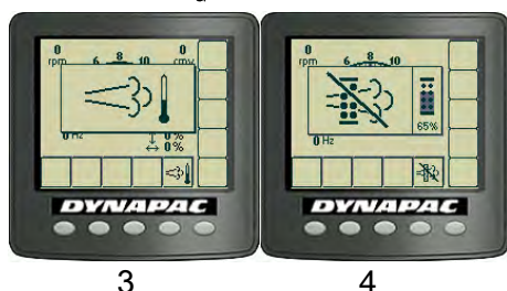
Фиг. Табло за управление 1. Лампа 2. Превключвател за забавено изгаряне в DPF филтъра 3. Висока температура на отработените газове 4. Забавено изгаряне
