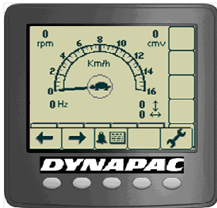
Rys. Na środku ekranu widać wybraną opcję (żółt, poślizg bębna, poślizg kół lub zajęc).
