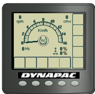
Rys. Na wyświetlaczu widać, czy kontrola przyczepności (system antypoślizgowy) jest włączona, czy wyłączona
