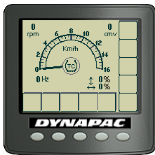
Afb. Het display heeft aan of de TC (anti-spin) geactiveerd is of niet.
