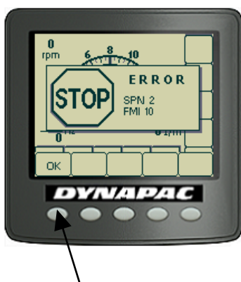
Joonis. Tihedusmõõtuuri küva (CMV-näidik)
