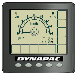
Joonis. Näidikul on näha, kas veojõu juhtimine (TC) (pöörlemisvastane funktsioon) on aktiveeritud/desaktiveeritud.
