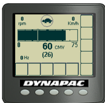
Joonis. Tihedusmõõtuuri küva (CMV-näidik)
