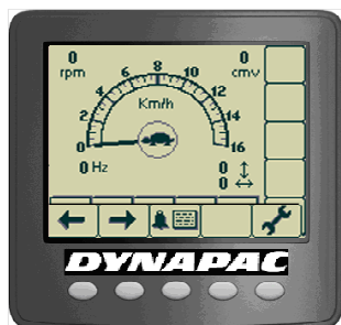
Joonis. Valikut kuvatakse ikooniga näidiku keskel (kilpkonn, rulli pöörlemine, rataste pöörlemine või jänes).
