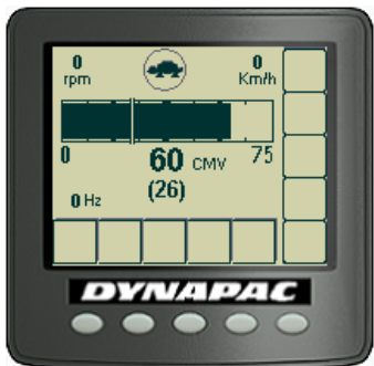
Kuva: Tiivistysmittari (CMV-näyttö)
