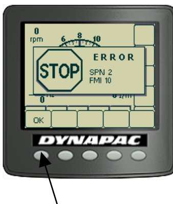
Kuva: Tiivistysmittari (CMV-näyttö)
