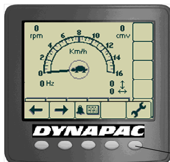
Kuva: päänäyttö/työnäyttö ja valintapainikkeet (1)
