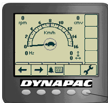
Kuva: päänäyttö/työnäyttö ja valintapainikkeet (1)
