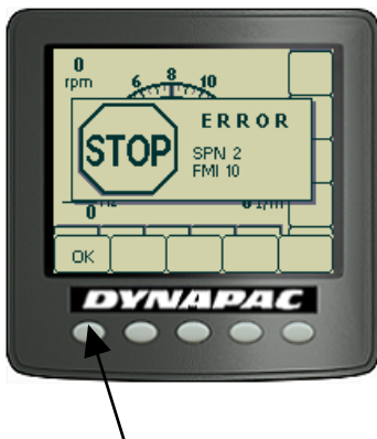
Kuva: Tiivistysmittari (CMV-näyttö)
