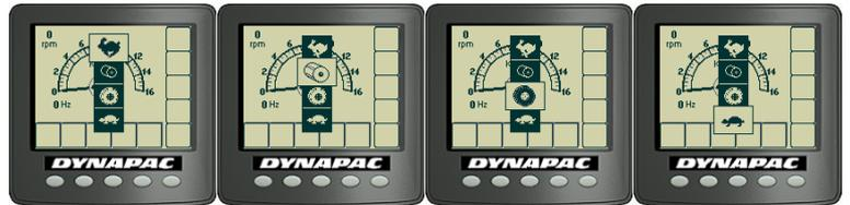
Die Getriebeposition der Walze wird in der Mitte der Geschwindigkeitsanzeige eingeblendet. Für die vorliegende Aufgabe den passenden Gang / die passende Drehzahl wählen.
