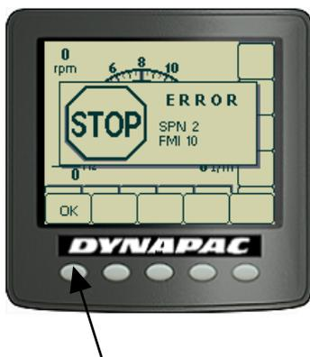
Wenn ein Motoralarm aktiviert ist, wird der Alarm auf dem Display angezeigt.
