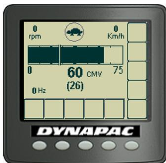
Abb.: Verdichtungsmesser-Display (CMV)
