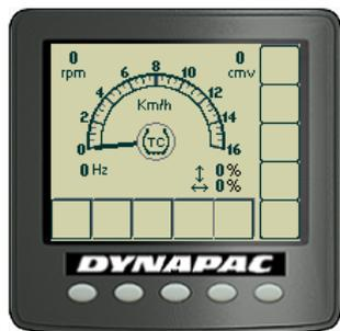
Abb.: Das Display zeigt an, ob TC (Anti-Spin) ein- oder ausgeschaltet ist.
