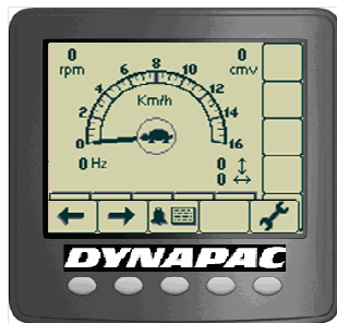
Abb.: Das Display zeigt die Auswahl in der Mitte (Schildkröte, Bandagendrehung, Raddrehung bzw. Hase).
