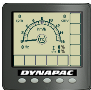
Abb.: Das Display zeigt an, ob TC (Anti-Spin) ein- oder ausgeschaltet ist.
