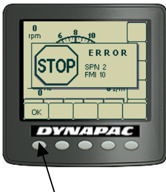
Fig. Pakkingsmålerdisplay (CMV-display)
